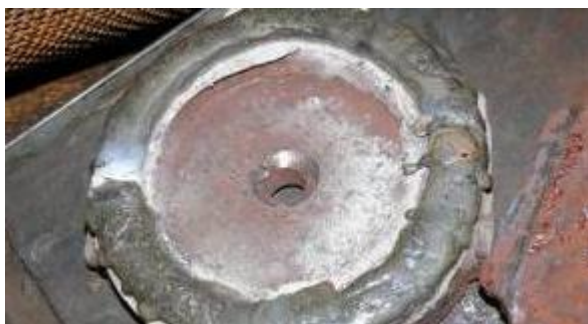
Рисунок 3.8 – Наплавленный клин арматуры
