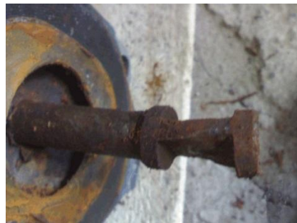
Рисунок 1.9 - Нарушение размеров штока
