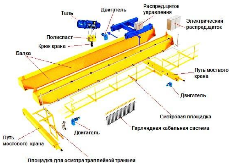
Рисунок 11. – Общее устройство мостового крана
