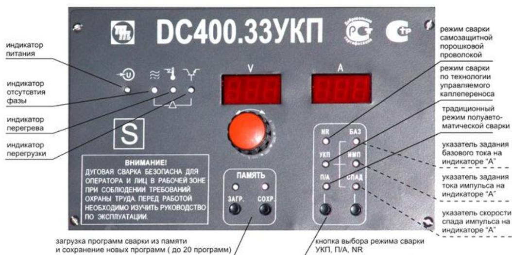
Рисунок 3.9 – Панель управления ДС400.33УКП
