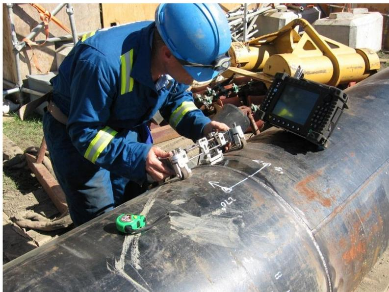
Рисунок 2.9 – Проведение ультразвукового контроля
