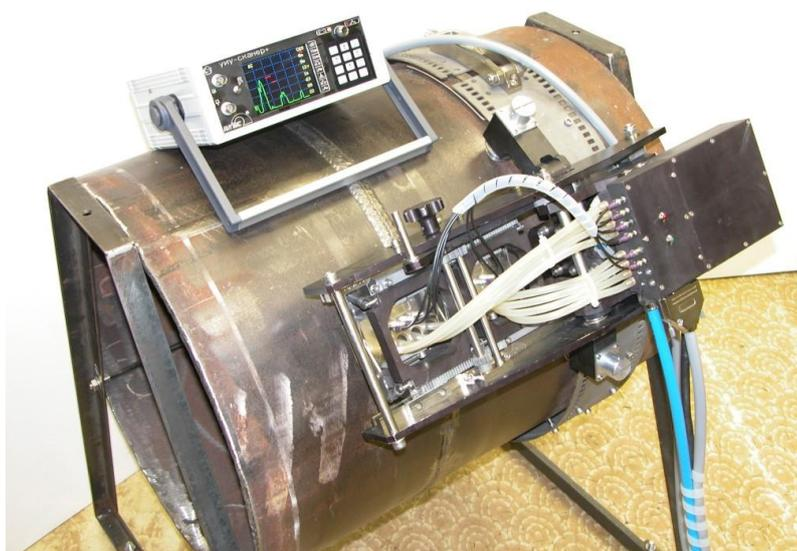
Рисунок 3.11 – Установка УЗК на трубе
