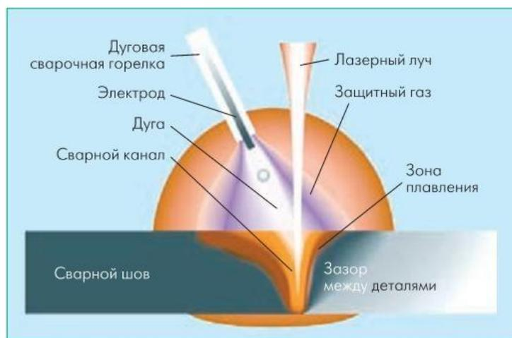
Рисунок 1.5 - Схема гибридной лазерно-дуговой сварки
