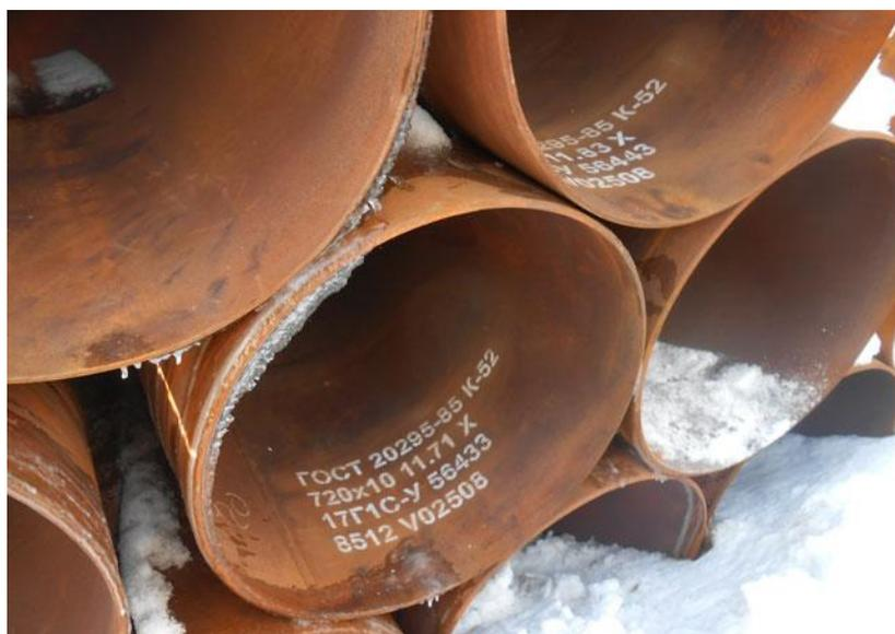
Рисунок 2.1 – Маркировка трубы
