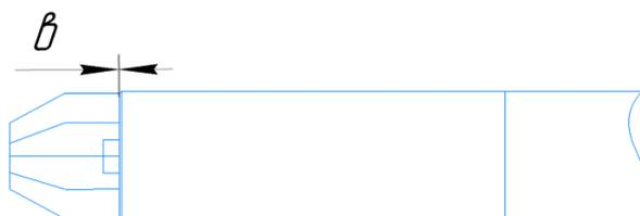
Рисунок 2.2 – Установка внутреннего центратора
