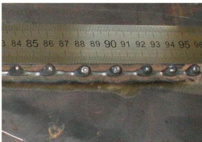
Рисунок 1.6 – Нестабильное формирование обратного валика сварного шва (хампинг) при гибридной лазерно-дуговой сварке
