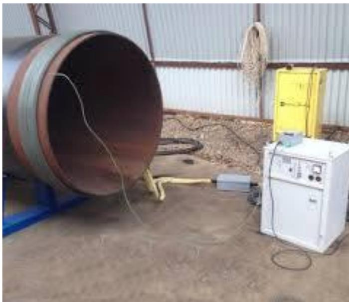
Рисунок 3.3 – Установка индукционного подогрева
