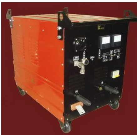
Рисунок 1.6 – Источник постоянного тока ВД-306 УЗ
