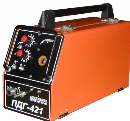
Рисунок 2.10 –Механизм для подачи ПДГ-421
