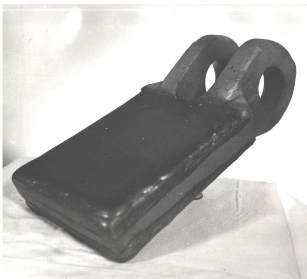
Рисунок 25 – Било с наплавленным слоем
