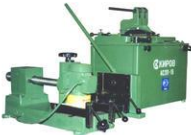
Рисунок 15 – Агрегат для пайки ленточных пил АСЛП-18
