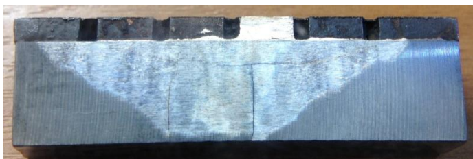
Рисунок 29 – Трещины на твердосплавной пластине
