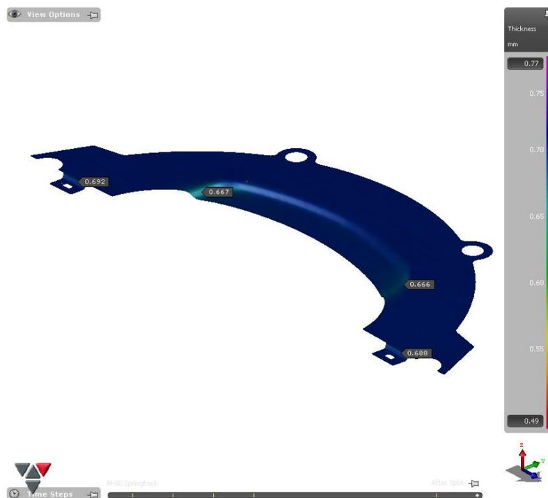
Рисунок 3.20 – Толщина изделия, в местах формообразования
