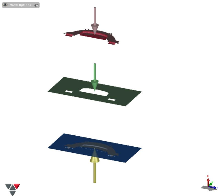
Рисунок 3.13 – Инструменты формообразующей операции
