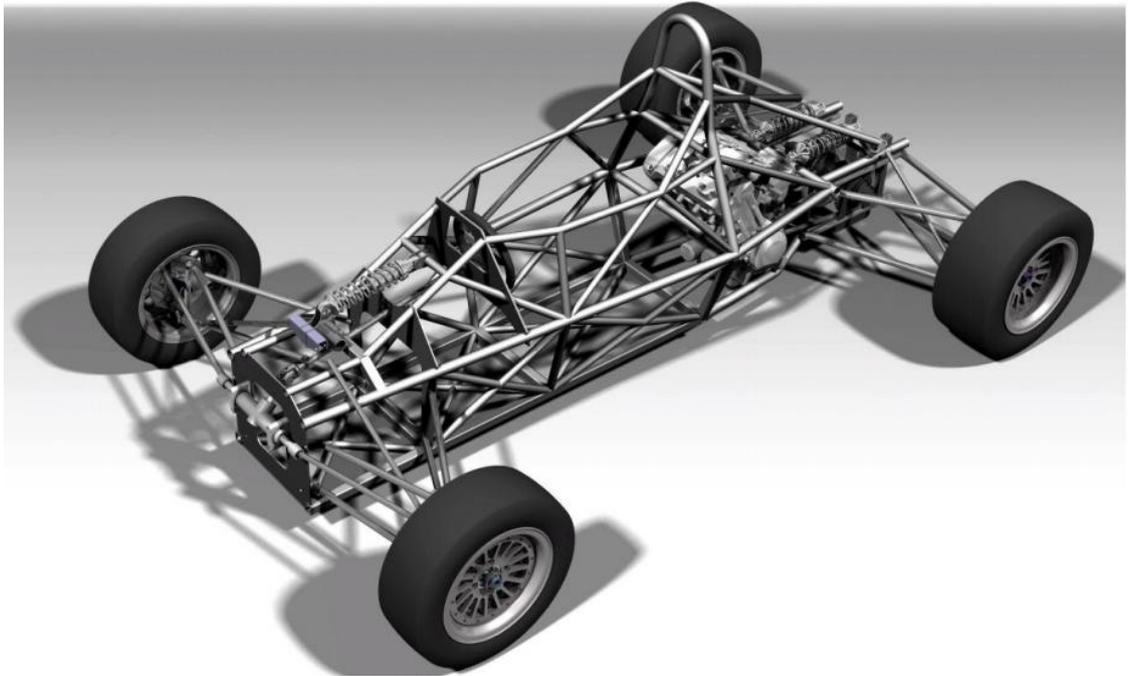
Рисунок 1.8 – Пространственный каркас гоночного болида Формула Юниор
