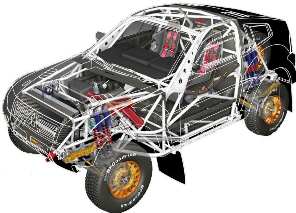
Рисунок 1.7 – Пространственный каркас гоночного автомобиля
