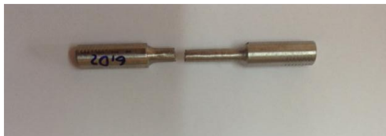
Рисунок 3.5. Разрушение паяных образцов после испытаний на длительную прочность.
