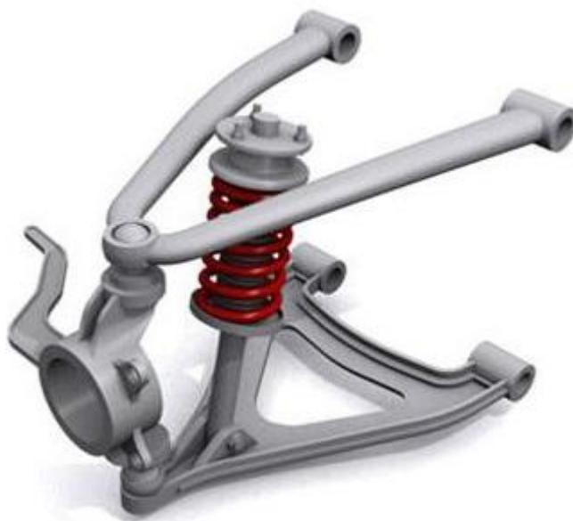
Рисунок 7 – Условное изображение подвески на двойных поперечных рычагах
