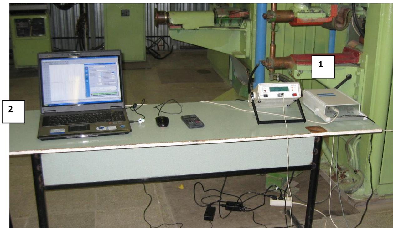
Рисунок 2.12 – Прибор для снятия осциллограмм электрических процессов сварки (1) и ПК (2)
