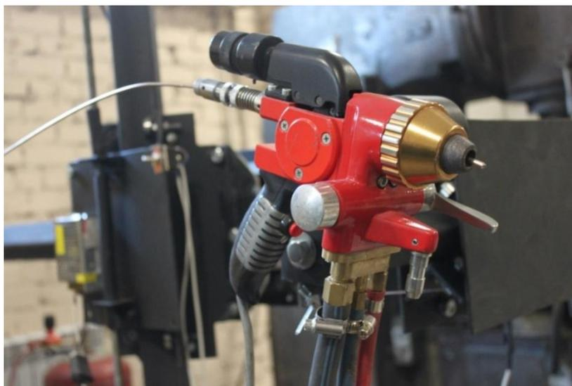
Рисунок 3. 1 – Установка для газопламенного напыления FS-15
