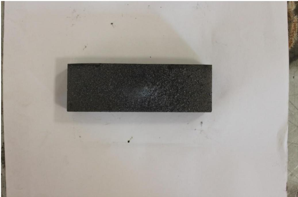
Рисунок 4.11 – Образец для испытания прочности сцепления с напыленным слоем при расстоянии от сопла до образца 50мм
