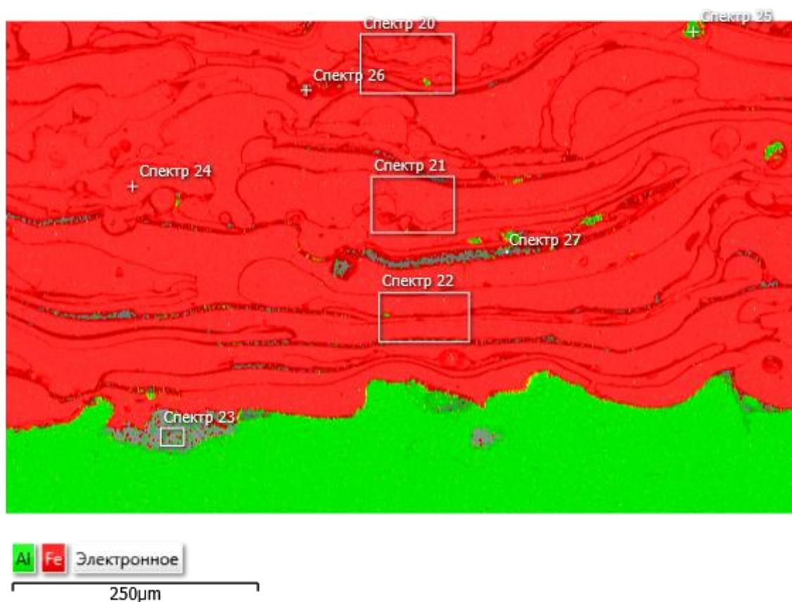
Рисунок 3.13 – Карта распределения элементов напыленного слоя
