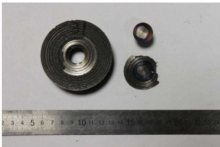
Рисунок 3.10 – Образцы для испытания прочности сцепления с различным характером подготовки поверхности
