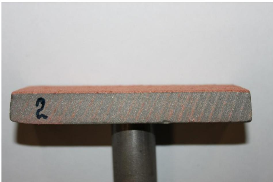
Рисунок 4.10 – Образец для испытания прочности сцепления с напыленным слоем на верхней плоскости
