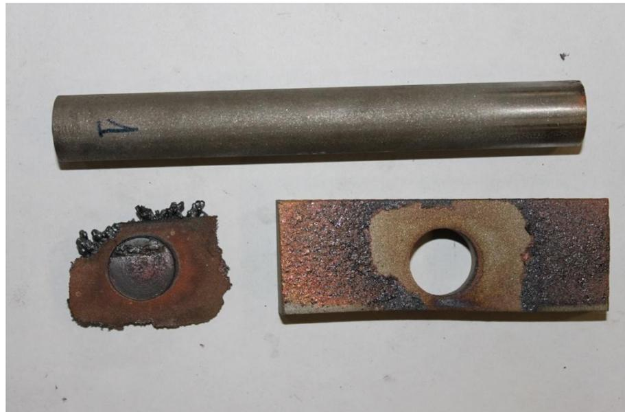
Рисунок 4.12 – Образец после испытания прочности сцепления с напыленным слоем
