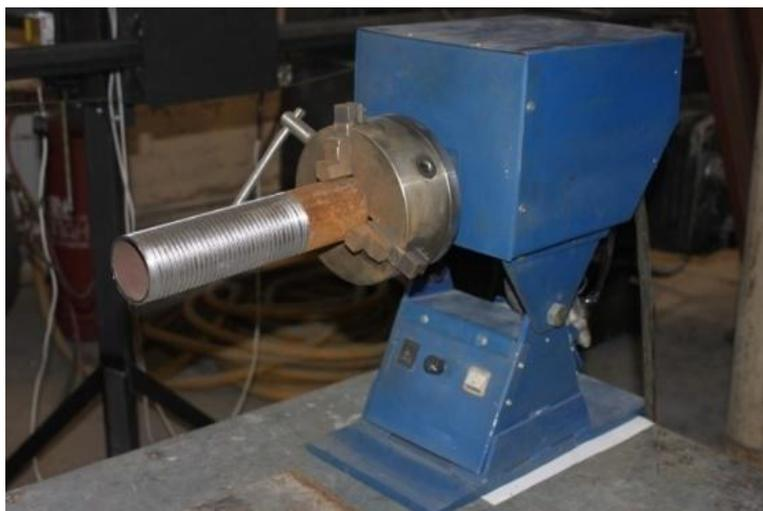
Рисунок 3.4 – Сварочный позиционер
