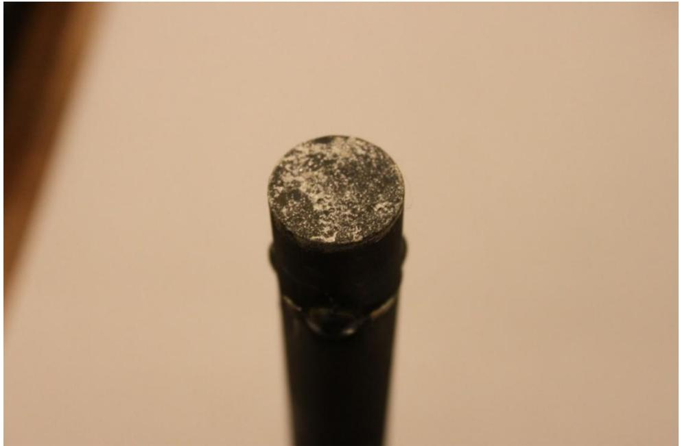
Рисунок 4.18 – Стержень после испытания прочности сцепления с
