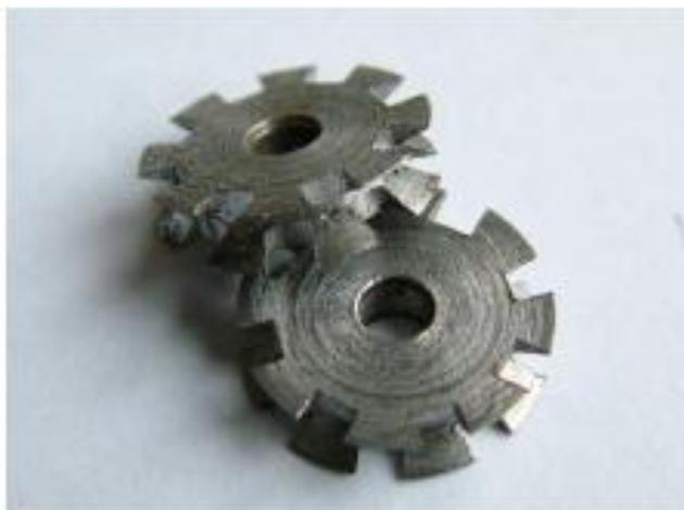
Рисунок 2.1 – Профилированные диски для получения замкового профиля
