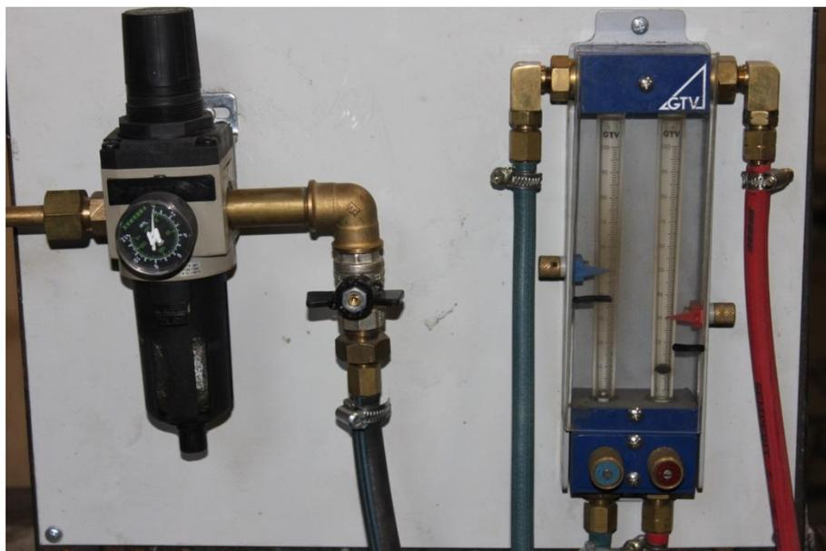
Рисунок 3.2. – Система воздухоподготовки и расходомер
