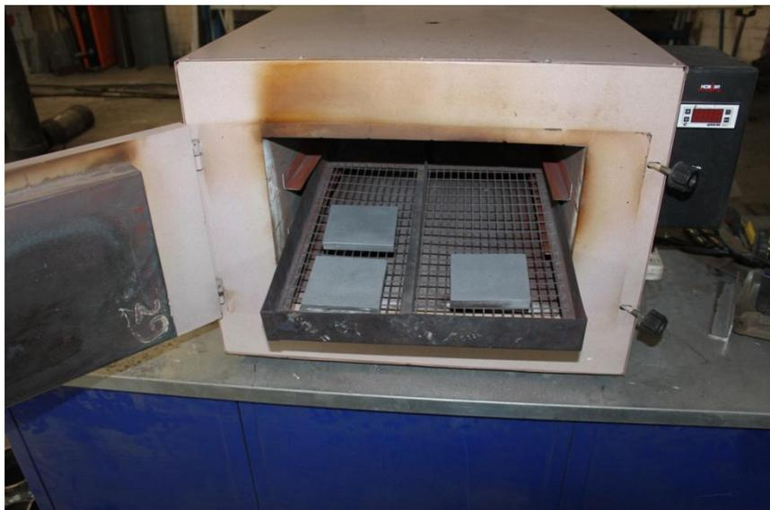
Рисунок 3.7 – Печь сопротивления с нагреваемыми образцами
