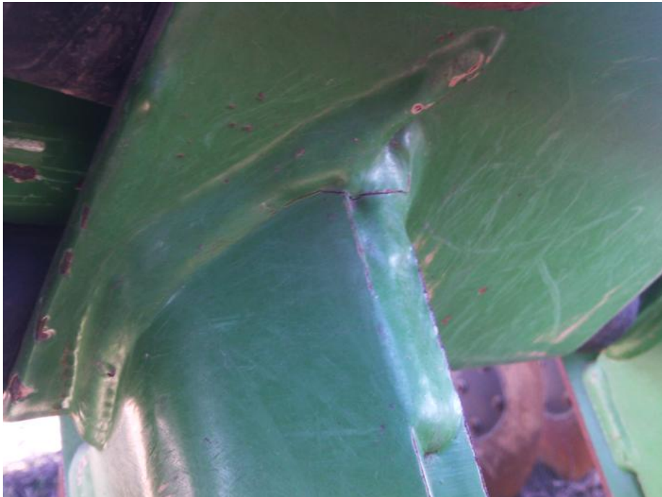
Рисунок 1.2 – Усталостная трещина на стойке диска Catros
