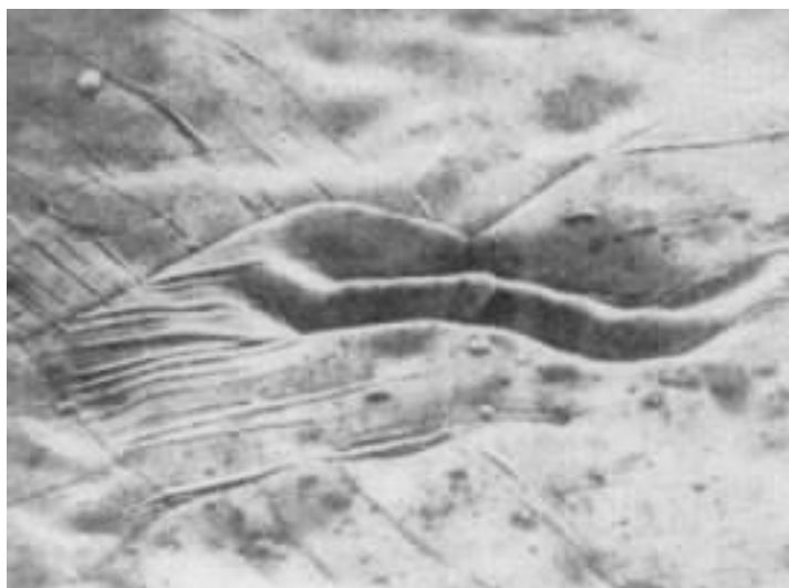
Рисунок 6 – Экструзии и интрузии, наблюдаемые в электронном микроскопе
