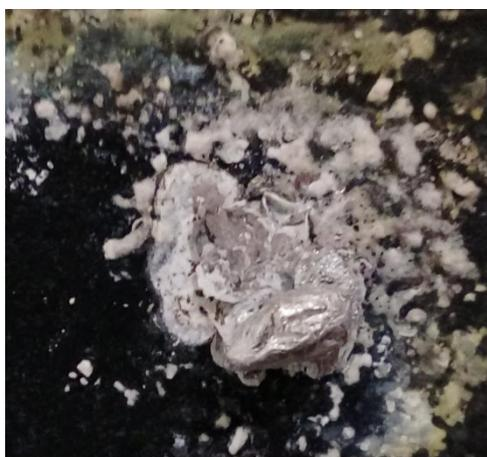
Рисунок 70 – Результат испытания на смачивание и растекание при температуре  $720^{\circ}\text{C}$  с применением флюса системы  $\text{NaCl-Na}_3\text{AlF}_6\text{-NaF}$
