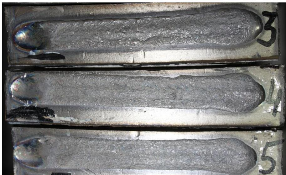
Рисунок 48 – Внешний вид наплавленных валиков №3, №4 и №5
