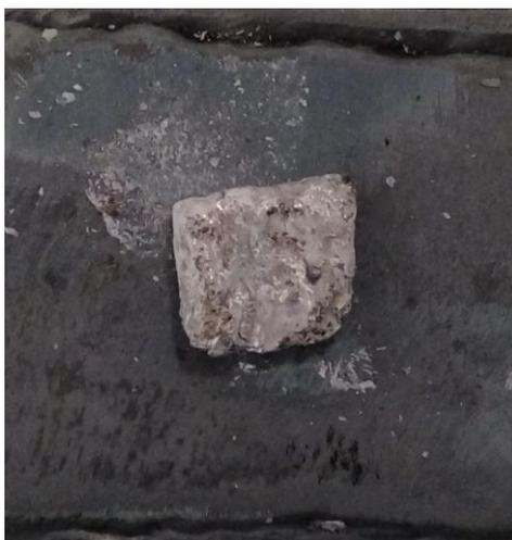
Рисунок 68 – Результат испытания на смачивание и растекание при температуре  $720^{\circ}\text{C}$  без применения флюса
