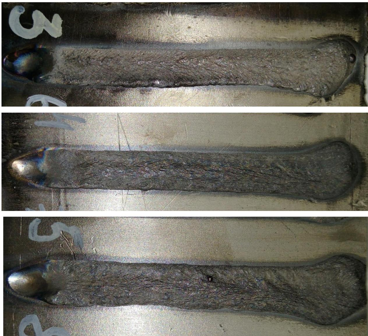
Рисунок 55 – Внешний вид наплавленных валиков с применением проволоки из меди М1 (валики №3, №4, №5)
