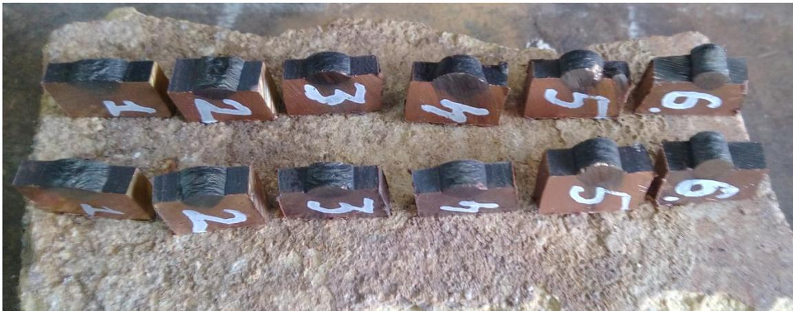
Рисунок 71 – Внешний вид образцов до испытания на термостойкость
