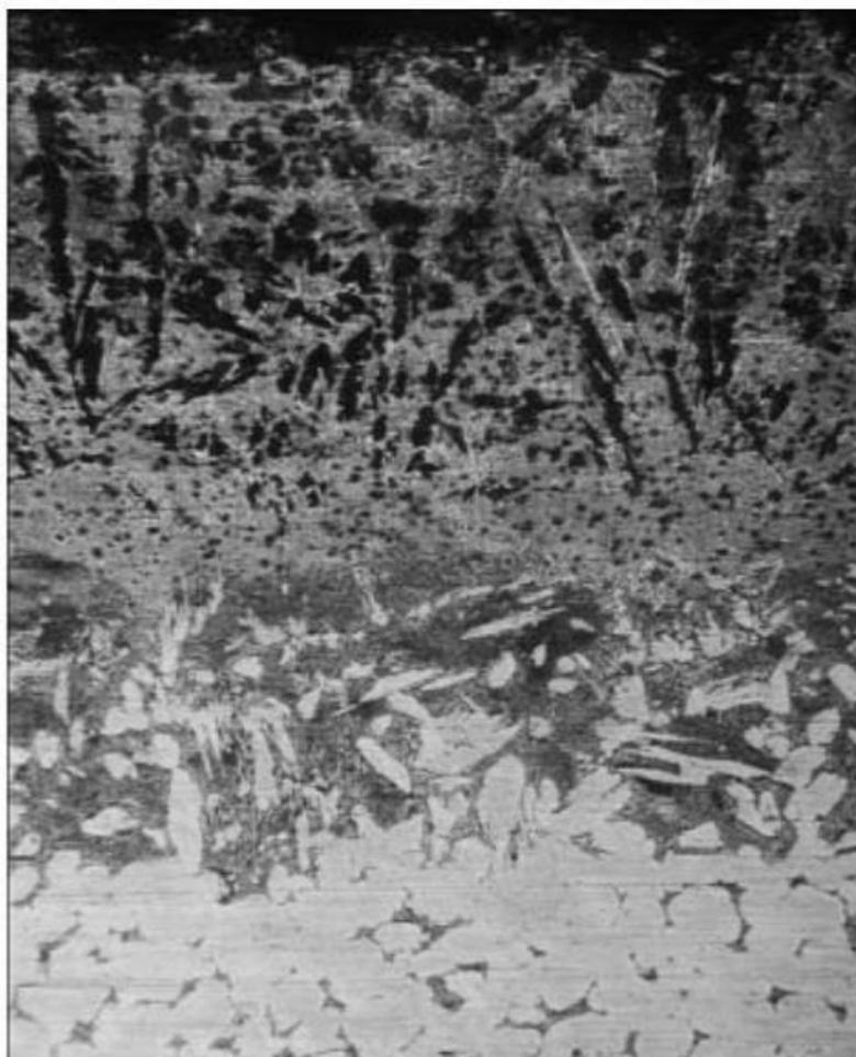
Рисунок 11 – Микроструктура покрытия на поверхности бронзы БрХ08 [19]
