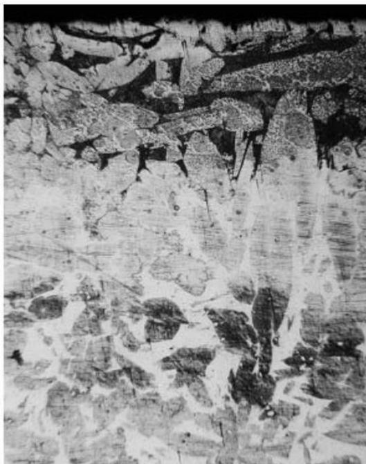
Рисунок 12 – Микроструктура покрытия на поверхности латуни ЛМцЖ-55-3-1,5
