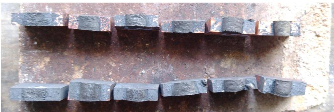
Рисунок 72 – Внешний вид образцов после 25 циклов испытания на термостойкость
