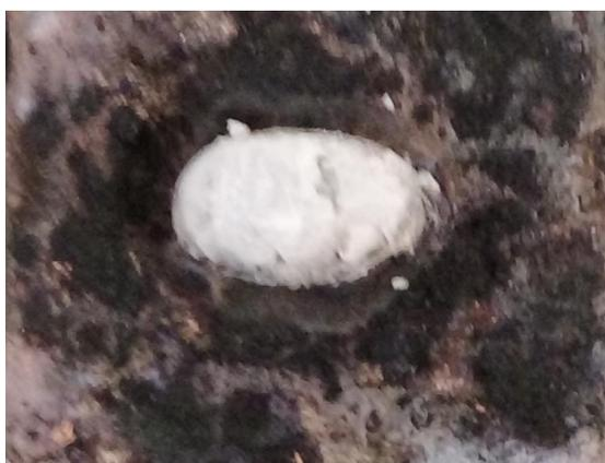
Рисунок 69 – Результат испытания на смачивание и растекание при температуре  $720^{\circ}\text{C}$  с применением флюса NOCOLOK
