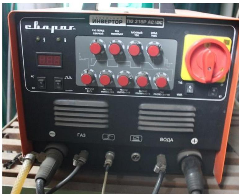
Рисунок 20 – Сварочный инвертор Сварог 315P AC/DC.
