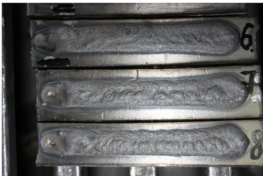
Рисунок 49 – Внешний вид наплавленных валиков
