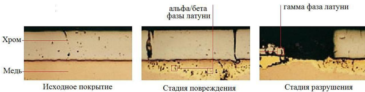
Рисунок 17 – Стадии разрушения хромового покрытия медного кристаллизатора
