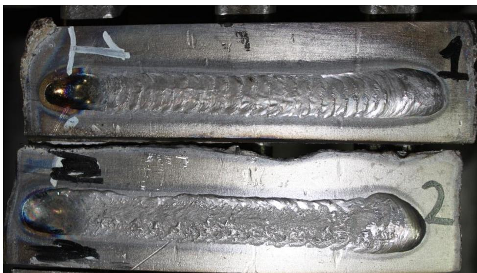
Рисунок 47 – Внешний вид наплавленных валиков №1 и №2
