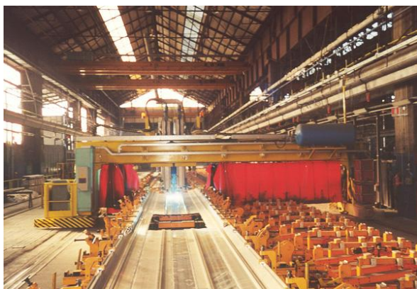
Рисунок 2.15 - Тандемная сварка при производстве железнодорожных вагонов, достигнутая скорость сварки: 250 см / мин.
