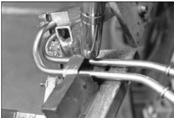
Рисунок 2.3 – Водоохлаждаемая горелка Robacta Drive Twin в положении для пайки тормозных цилиндров
