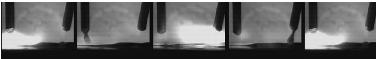
Рисунок 2.7 – Горение сварочных дуг при сварке по технологии Time Twin
