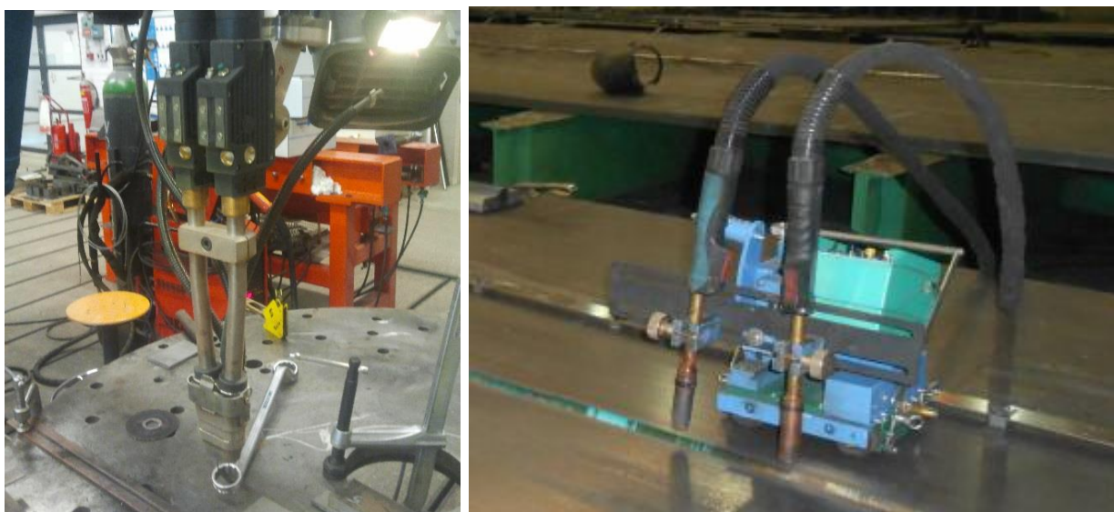
Рисунок 1.5 – Оборудование для двухдуговой тандемной сварки
