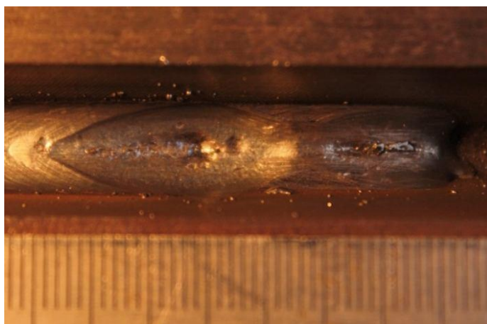
Рисунок 3.5 – Окончание сварного шва при двухдуговой сварке на заданных режимах
