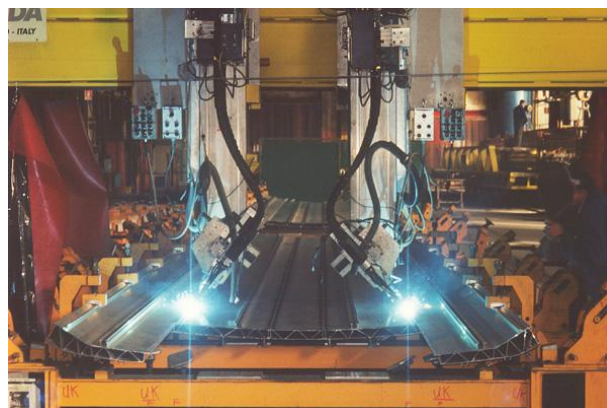
Рисунок 2.15 - Тандемная сварка при производстве железнодорожных вагонов, достигнутая скорость сварки: 250 см / мин.
