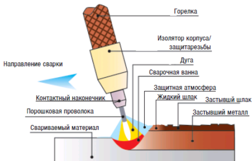
Рисунок 2.3 – Сварка порошковой проволокой
