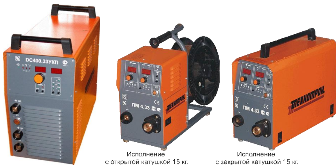
Рисунок 2.6 – Источник питания механизированной сварки с управляемым каплепереносом ДС 400.33 УКП и механизм подачи проволоки ПМ-4.33 (производства «ТехноТрон», Россия)
