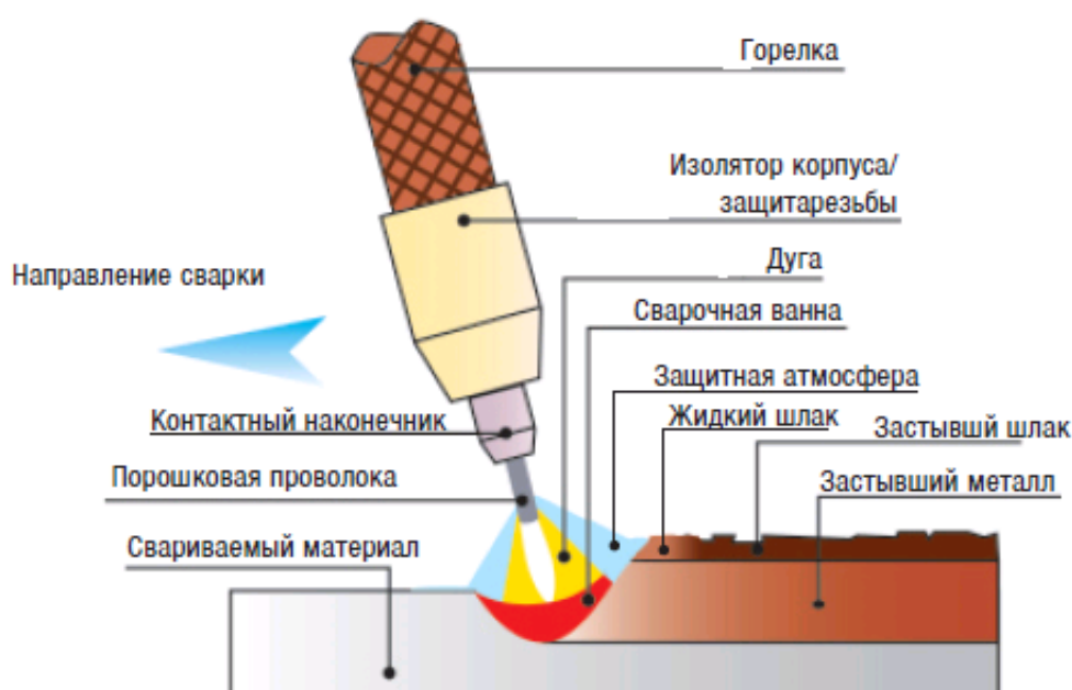
Рисунок 2.3 – Схема сварки с применением порошковой проволоки
