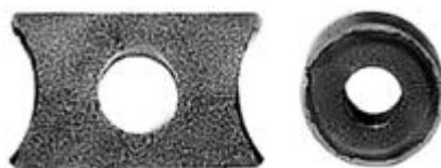
Рисунок 1.5 - Образцы для испытания на трение. Диск и колодка.
