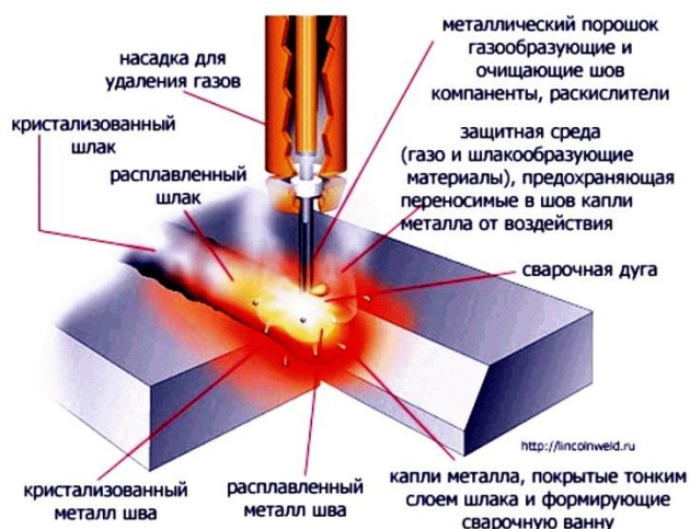
Рисунок 2.2 – Схема сварки самозащитной проволокой
