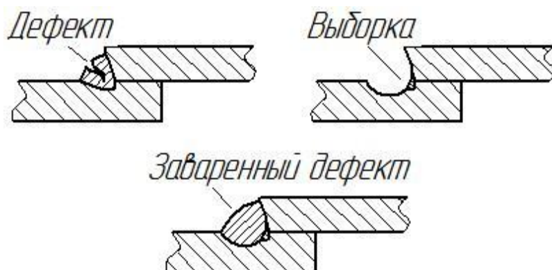
Рисунок 2.10 – Условная схема выполнения технологической операции «исправление дефектов»
