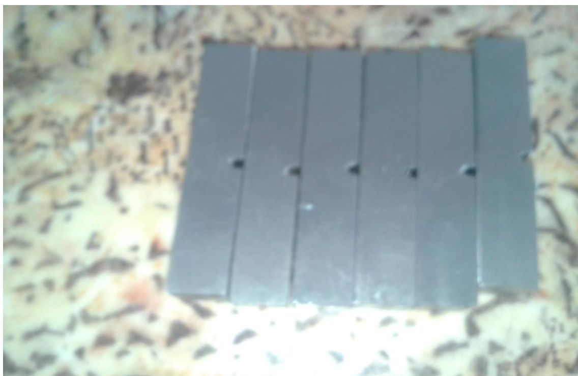
Рисунок 2.9 – Образцы для измерения угла загиба
