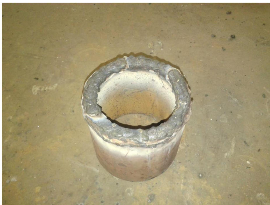
Рисунок 2.3 - Образец с наплавленными кромками
