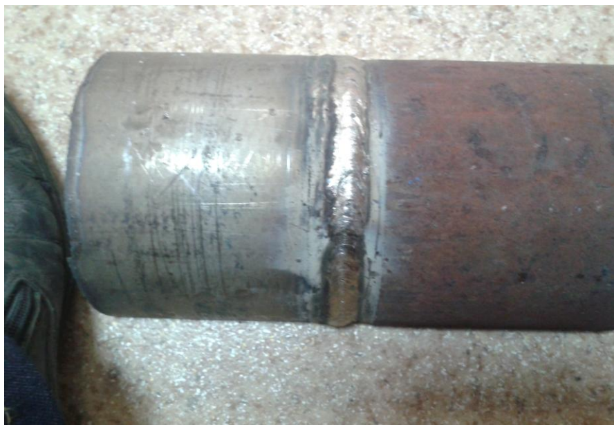
Рисунок 2.5 – Сварной образец из разнородных сталей
