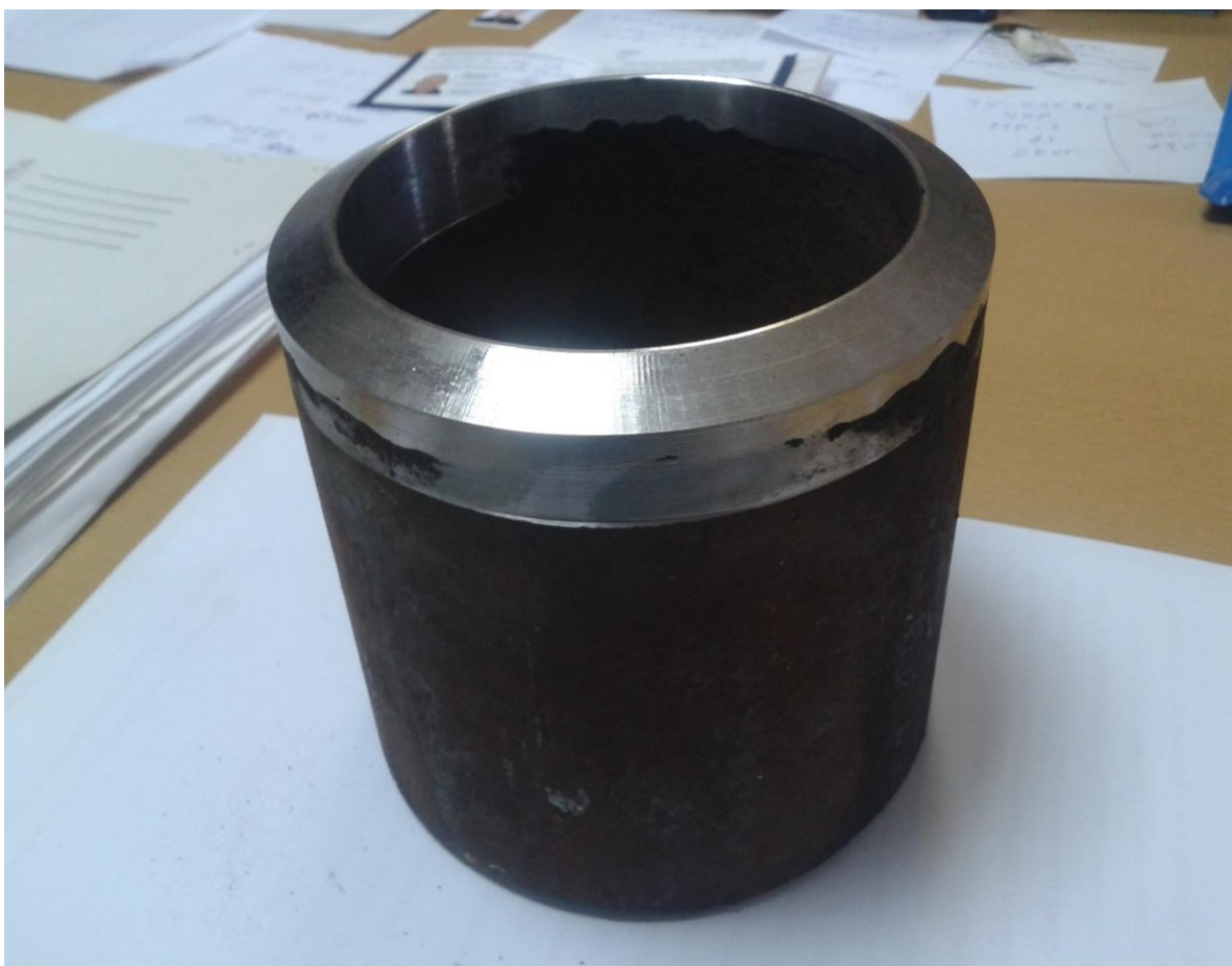
Рисунок 2.4 – Подготовка кромок под сварку после наплавки
