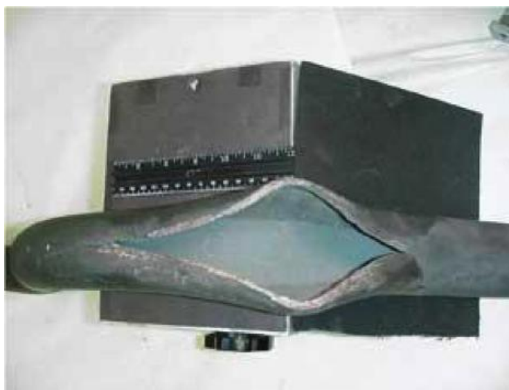
Рисунок 1.5 - Разрушение трубопровода из-за потери жаростойкости при воздействии высоких температур и давления
