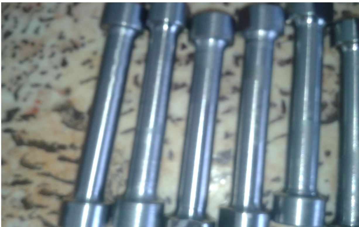
Рисунок 2.7 - Образцы для механических испытаний
