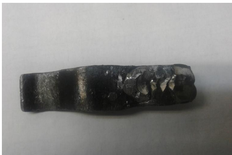
Рисунок 1.4 – Контролирующая планка требующая ремонта
