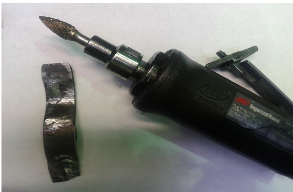
Рисунок 2.2 – Контролирующая планка и фрезерная пневматическая машинка
