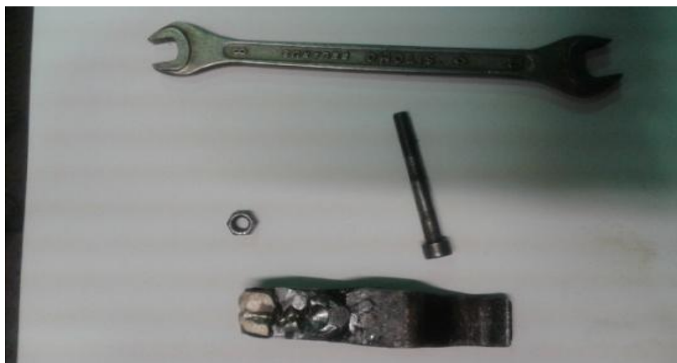
Рисунок 2.2 – Изношенная контролирующая планка и инструмент
