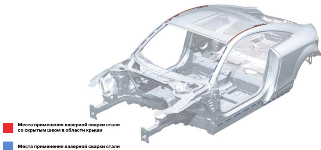
Рисунок 7- Лазерная сварка со скрытым швом
