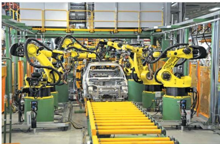
Рисунок 12 – Линия автоматической контактной сварки легкового автомобиля ВАЗ-2190
