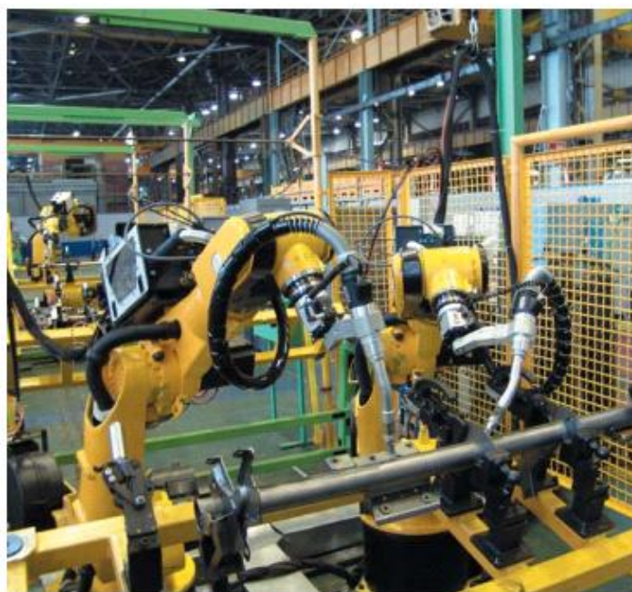
Рисунок 14 –РТК автоматической дуговой сварки поперечины панели приборов автомобиля ВАЗ-2190
