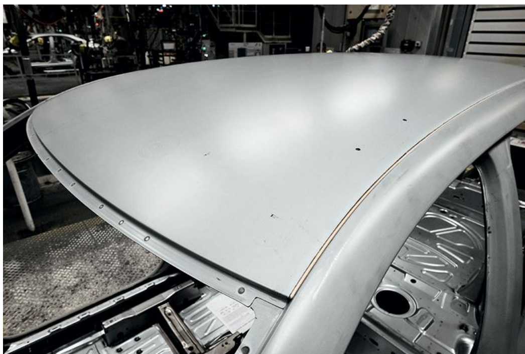
Рисунок 18 – Тонкая золотистая полоска лазерной пайки на крыше седана
