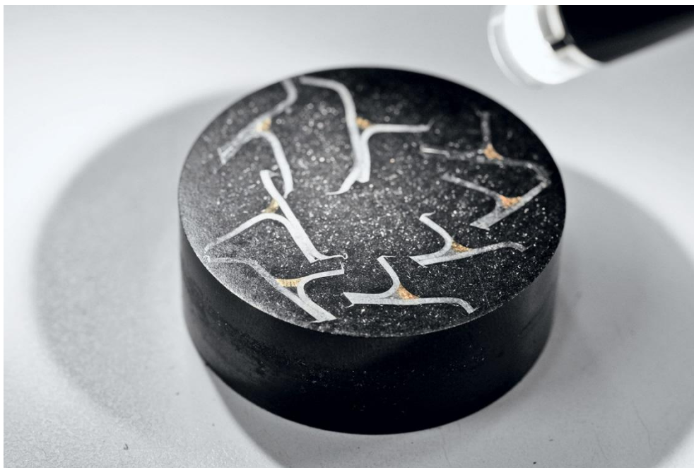
Рисунок 20 – Множественные срезы пайки крыши седана Polo, запеченные в «шайбе» из композитного материала
