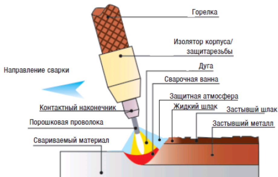
Рисунок 1.21 – Схема сварки порошковой проволокой
