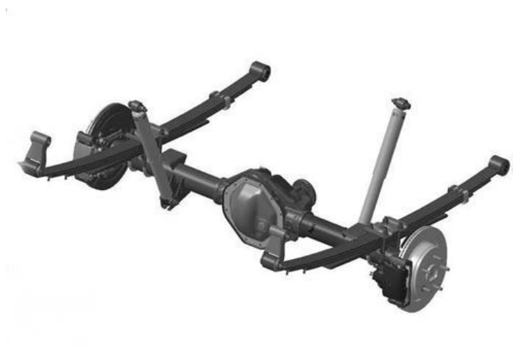
Рисунок 1.3 Рессорная зависимая подвеска автомобиля.
