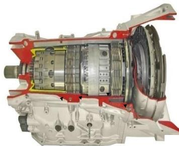
Рисунок 1.7 - Гидромеханическая коробка передач с автоматическим управлением.
