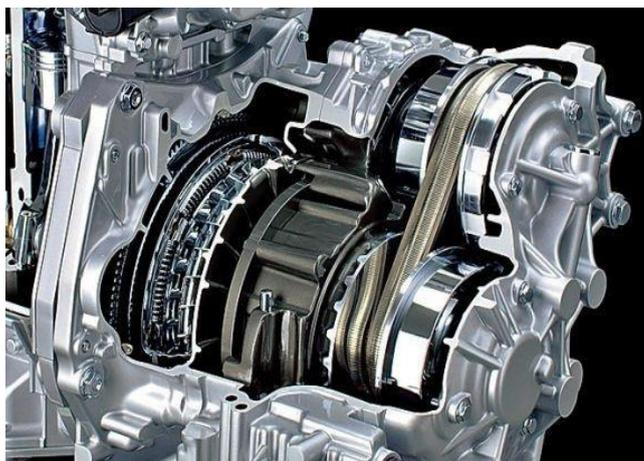
Рисунок 1.1 - Бесступенчатый редуктор-вариатор с клиноременной передачей крутящего момента
