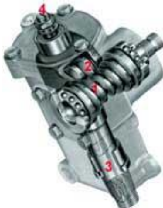
Рисунок А.1 - Рулевой механизм типа червяк двух-гребневый – ролик
