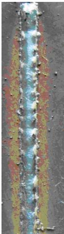
Рисунок 10- Внешний вид образца № 31 при  $\partial U / \partial I = 0,01 \text{ В/А}$
