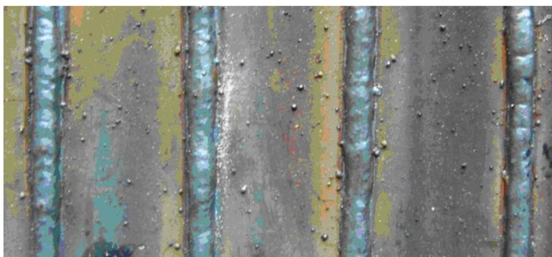
Рис.12 - Внешний вид образцов № 53 - 56 при  $\partial U / \partial I = 0,01$  В
