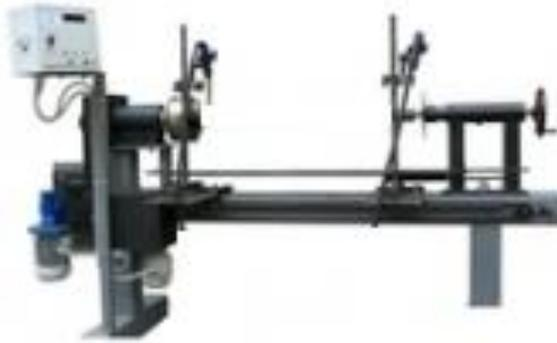
Рисунок 6 – Сварочный вращатель ТОМ - 16С.
