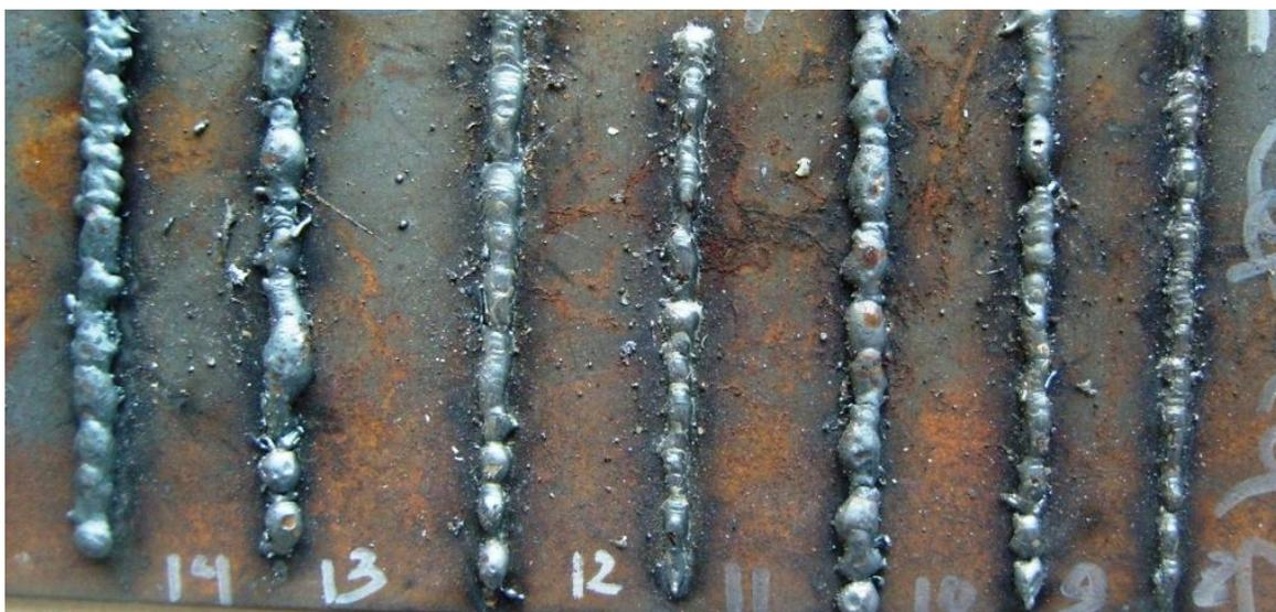
Рисунок 8 - Внешний вид образцов № 8-14 при  $\partial U/\partial I = 0,025$  В/А
