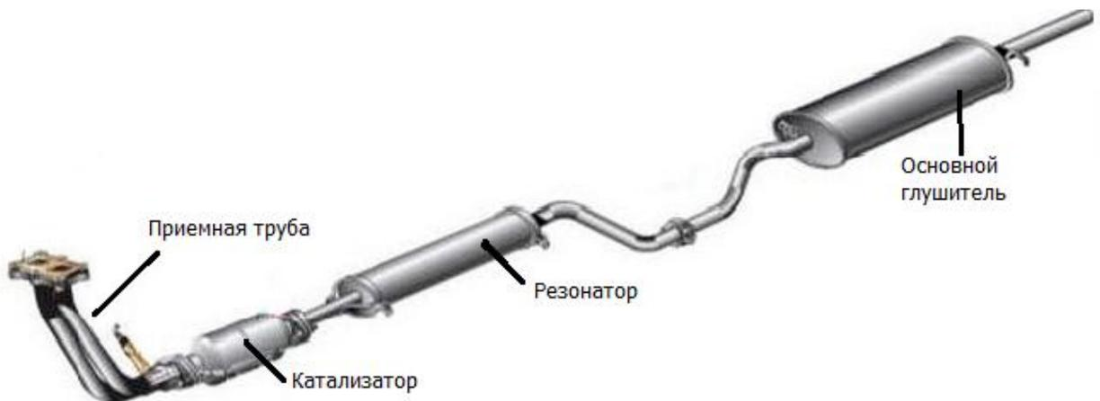
Рисунок 1 - Элементы системы выпуска отработанных газов.
