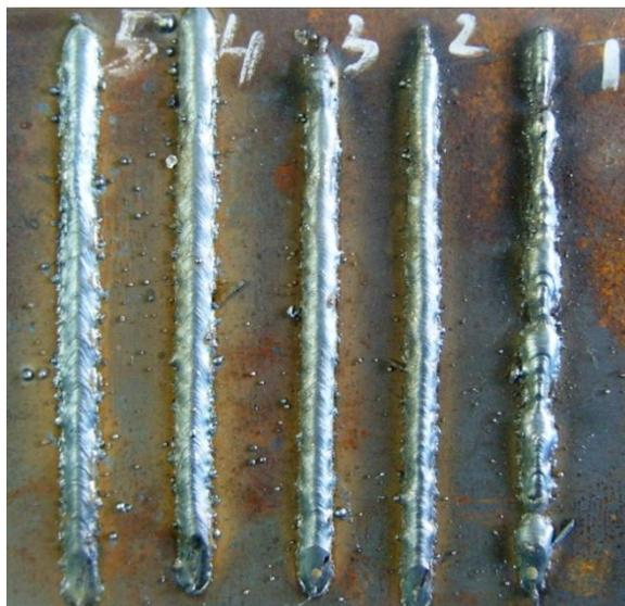
Рисунок 9 - Внешний вид образцов №1-5 при  $\partial U/\partial I = 0,01$  В/А
