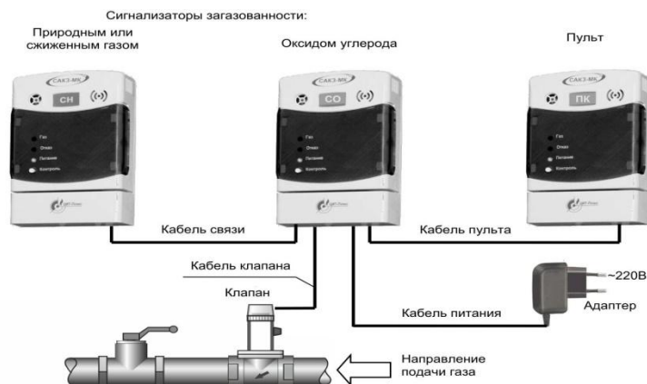
Рисунок 7.1 – Структурная схема установки САКЗ-МК-1-1А.
