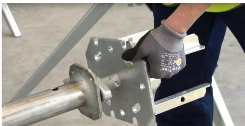
Рисунок 3.2 – Устройство крепления головки и опорной стойки
