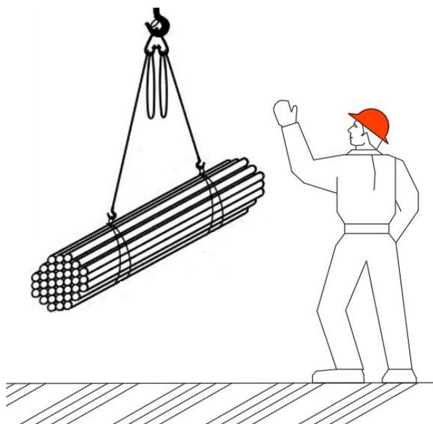
Рисунок 3.7 – Строповка арматурных стержней
