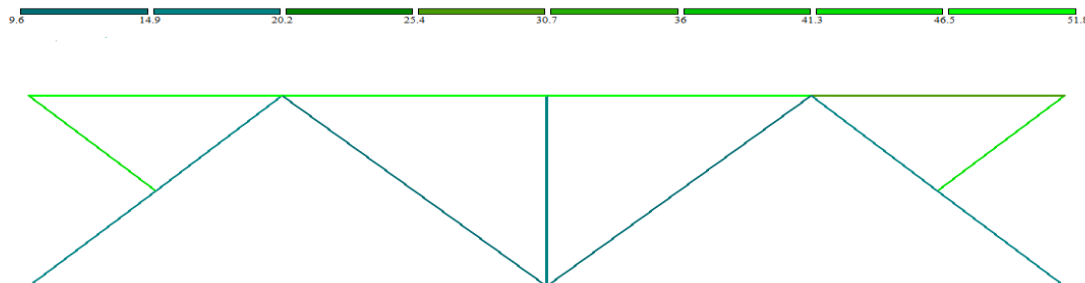
Рисунок 2.9 – Проверка назначенных сечений по 2 группе ПС
