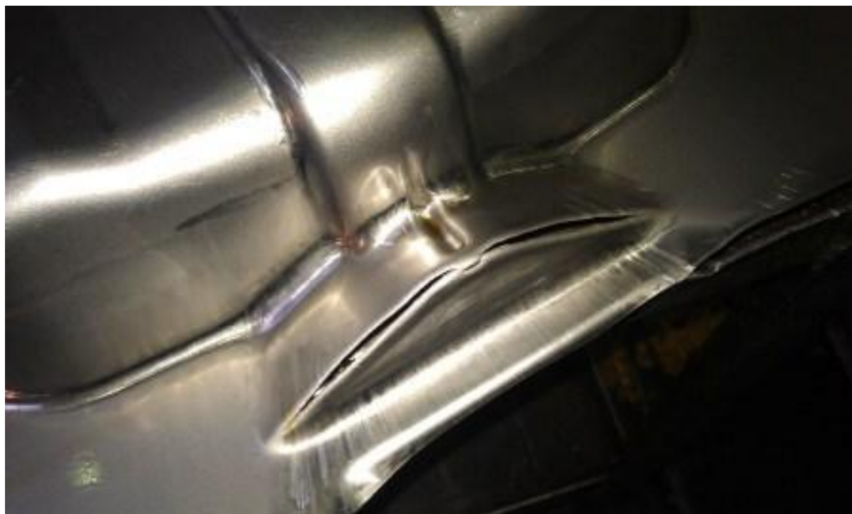
Рис 1.1. Разрывы на детали 755825359R
