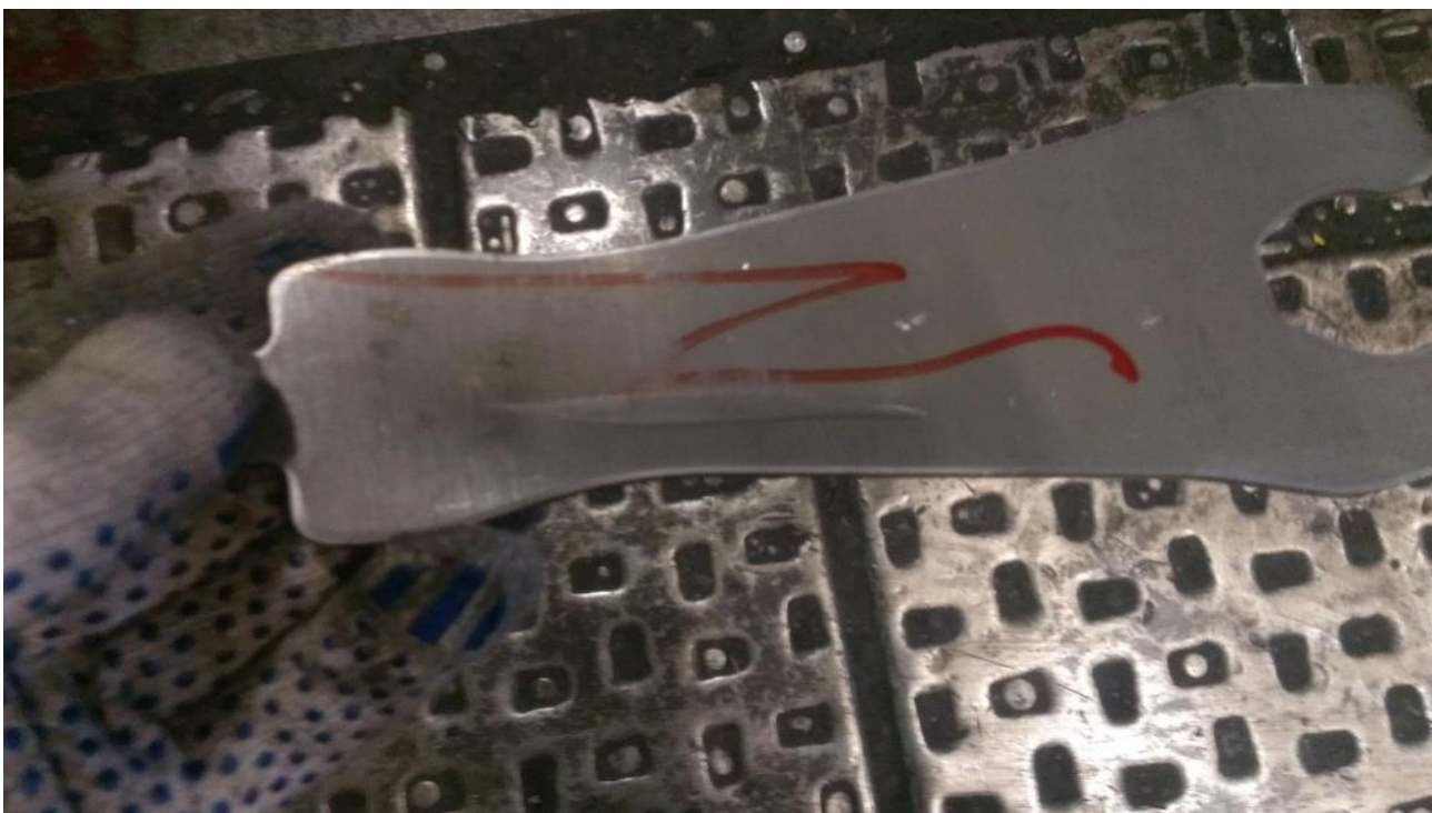
Рис 1.16 Дефект связанный с попаданием грязи в рабочие инструменты.
