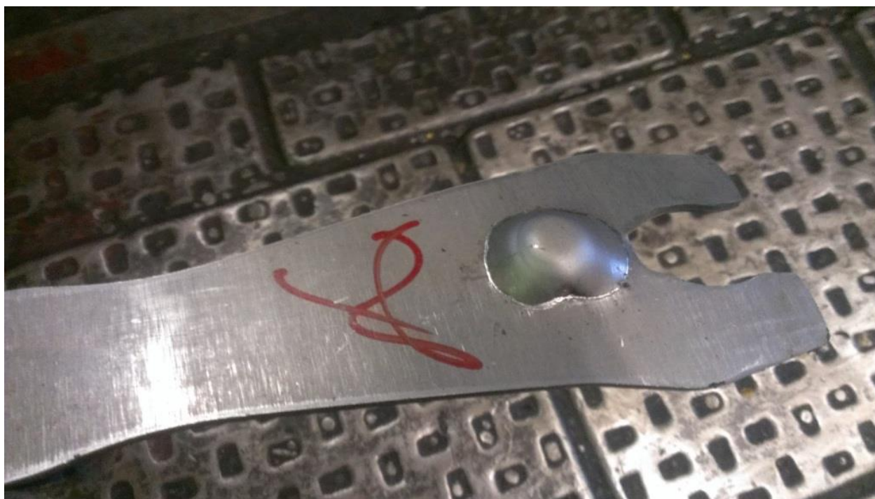
Рис 1.17 Дефект связанный с попаданием грязи в рабочие инструменты.
