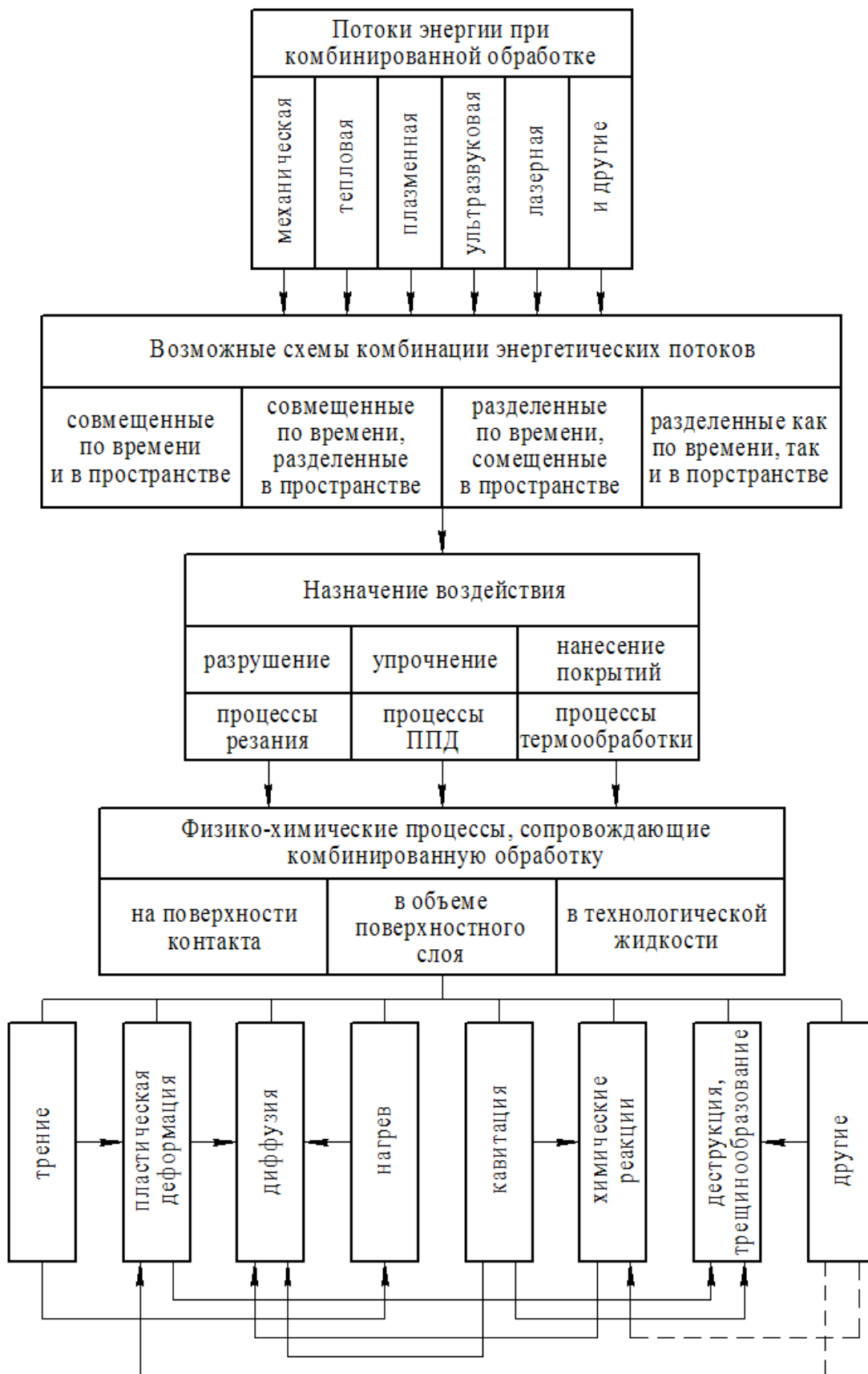
Рисунок 1.1 – Структурная схема физико-химических процессов при комбинированной обработке
