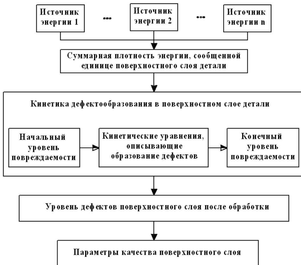
Рисунок 1.9 – Структурная схема анализа самоорганизации поверхностного слоя при введении дополнительных источников энергии
