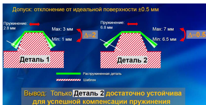
Рисунок 4.24 Пример анализа для компенсации пружинения
