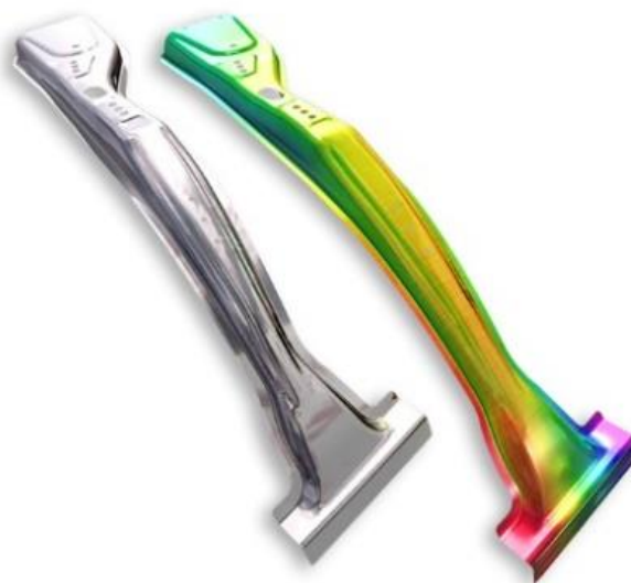
Рисунок 3.1 Результат расчёта пружинения
