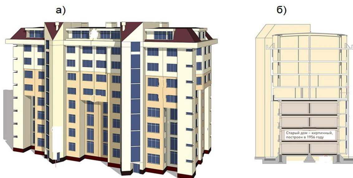
Рисунок 1.1 - Реконструкция здания с надстройкой: а - фасад; б – разрез
