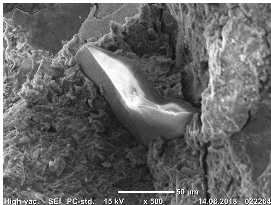
Рисунок 3.12 – Зерно стекла в цементном камне при увеличении в 500 раз
