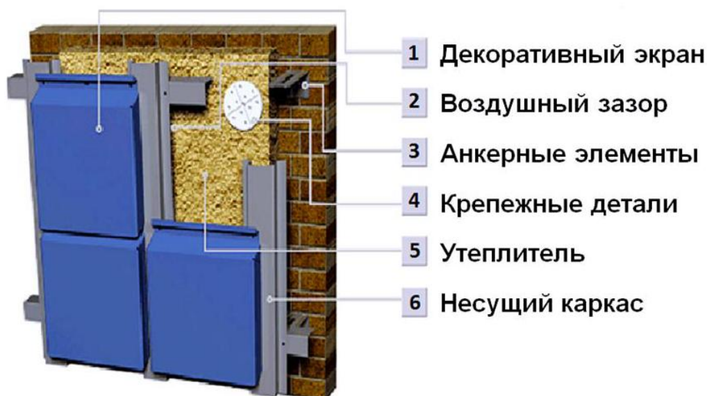
Рисунок 1.3 - Конструкция вентилируемого фасада[25]
