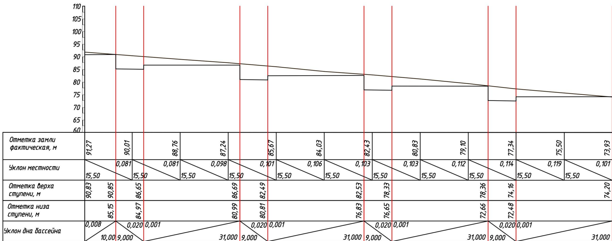
Рисунок 3.8 - Продольный профиль вписанного в местный рельеф каскадного фонтана
