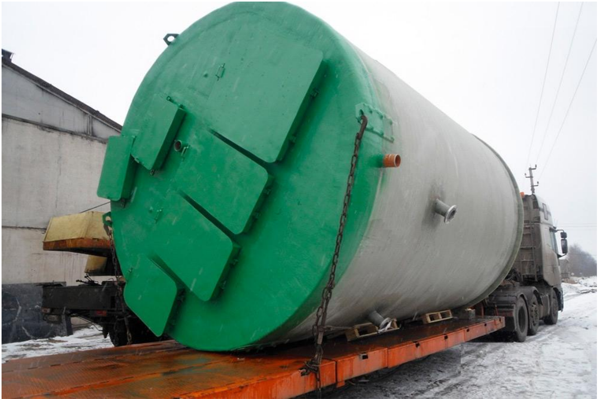
Рисунок 3.3 – Транспортировка стеклопластикового колодца.
