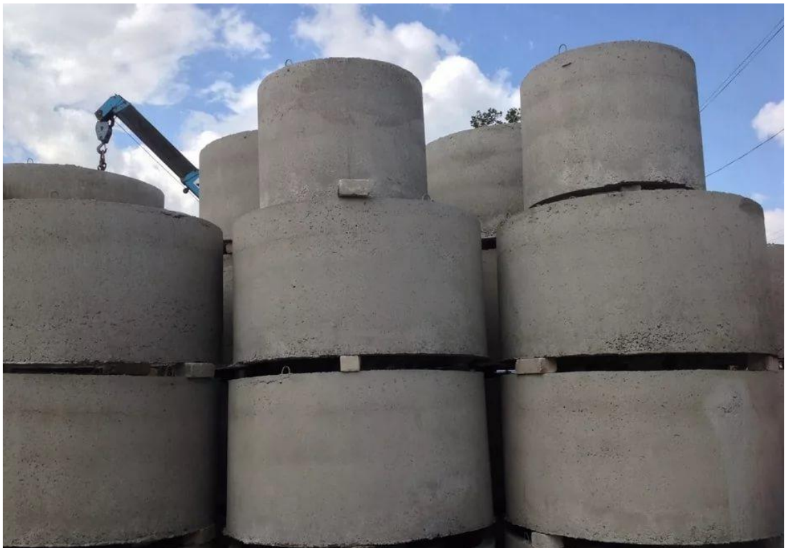
Рисунок 3.4 – Хранение железобетонных колец
