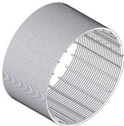
Рисунок 2.16 – Направление фильтрации снаружи - внутрь
