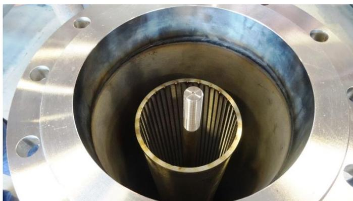
Рисунок 2.13 – ФЭЛ из нержавеющей конструкции «ТЭКО-СЛОТ».
