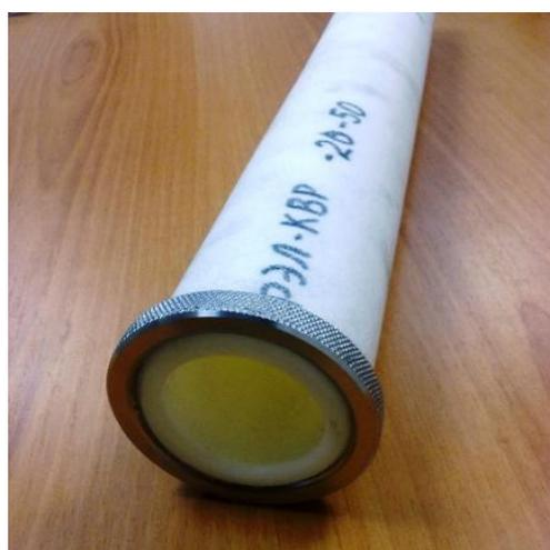
Рисунок 2.14 – ФЭЛ из пористых полимерных материалов.
