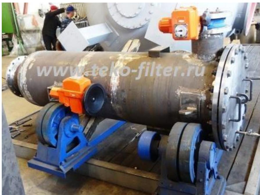
Рисунок 2.9 – Корпус фильтра самопромывного механической очистки.
