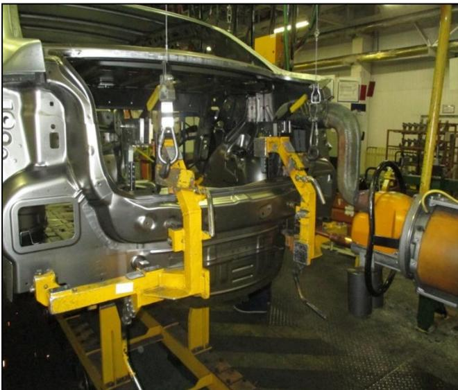
Рис.20 Приспособление для монтажа «Юбка задняя» на кузов
