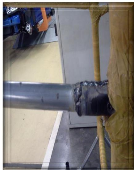
Рис.26 Стеллаж с не заизолированными кромками
