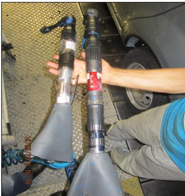
Рис.29 Защита на пневмо- и ручной механизированный инструмент
