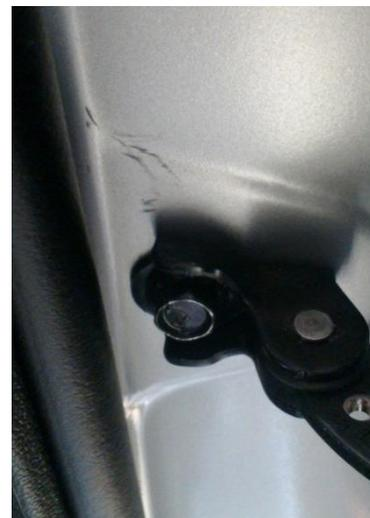
Рис.36 Дефект «Короб передней левой двери – сдир до металла»
