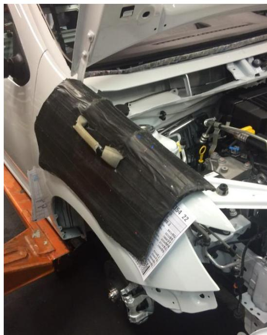
Рис.30 Защитная наклейка на крыло автомобиля
