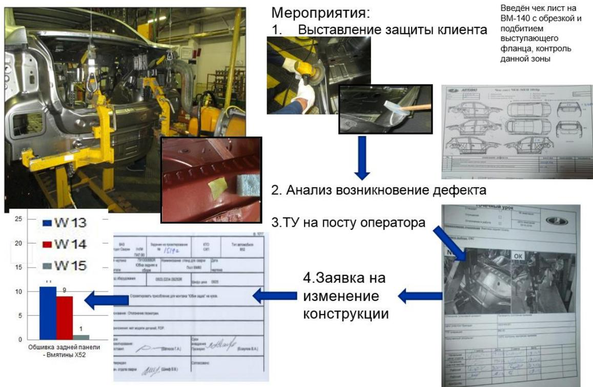
Рис.33 Пример по отработке дефекта мастером
