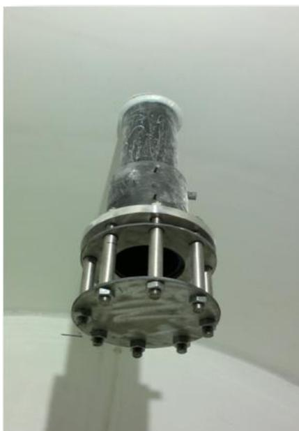
Рисунок 4.8 – Комплектация емкости: напорогаситель
