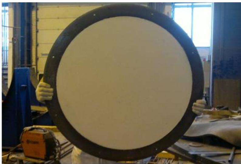
Рисунок 4.9 – Комплектация емкости: крышка люка
