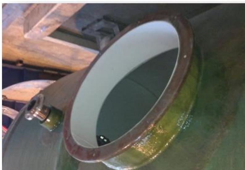
Рисунок 4.10 – Комплектация емкости: люк-лаз
