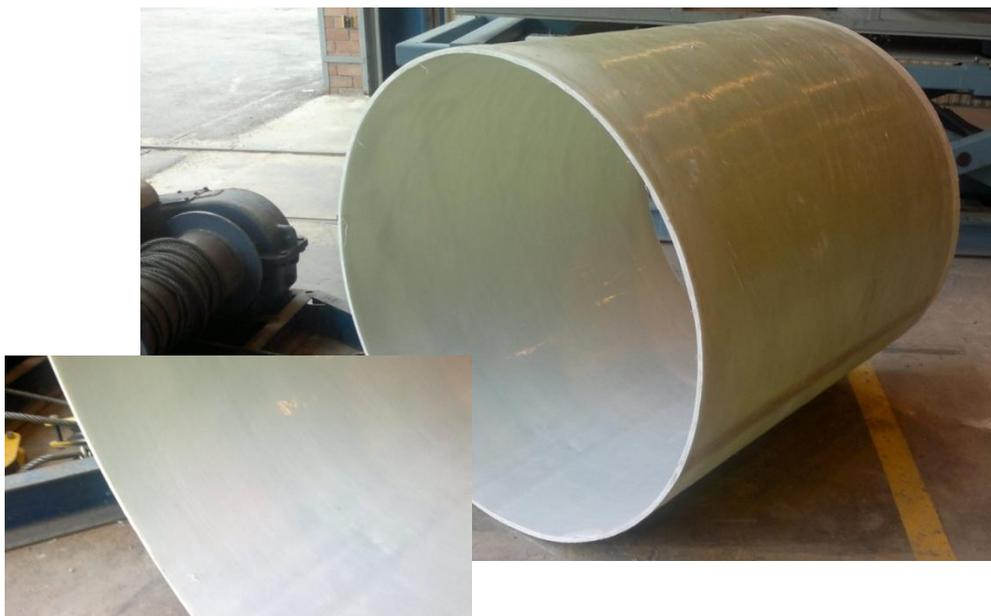
Рисунок 4.4 – Стеклопластиковая труба с внутренним слоем из кашированного ПНД
