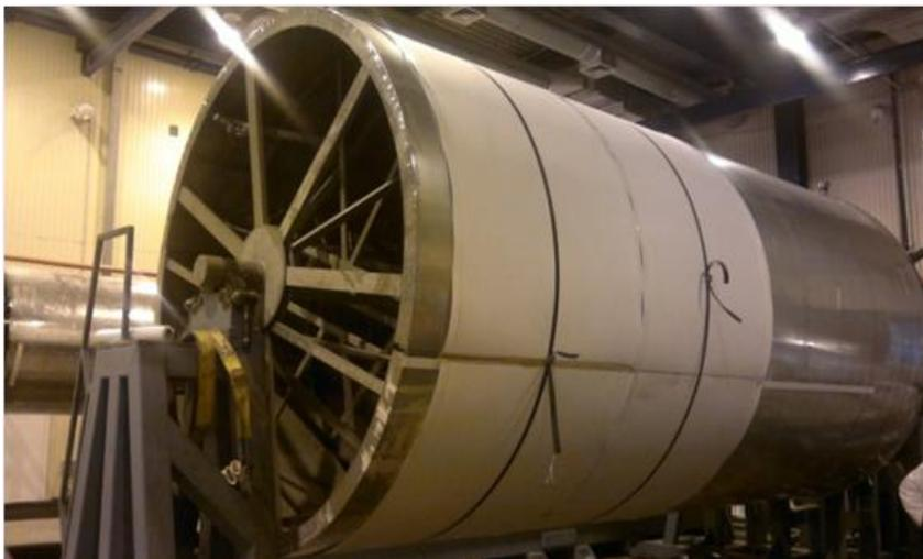
Рисунок 4.5 – Формирование цилиндра из листового ПЭ
