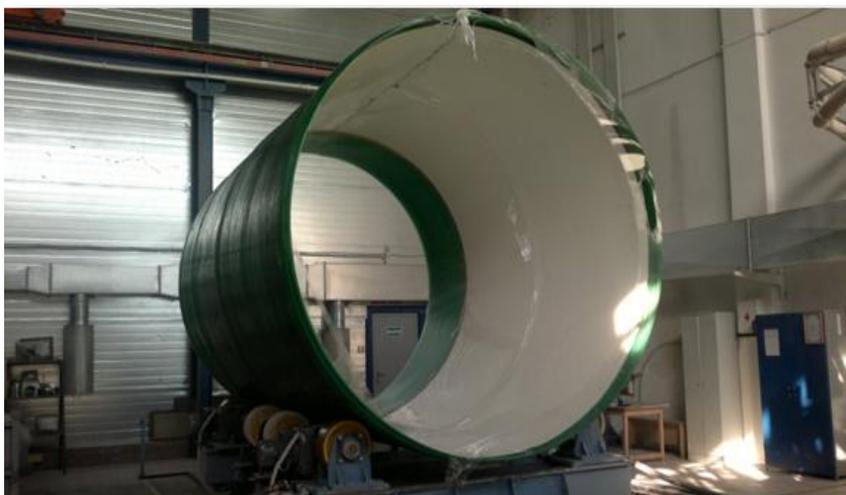
Рисунок 4.6 – Извлечение намотанного цилиндра с оправки
