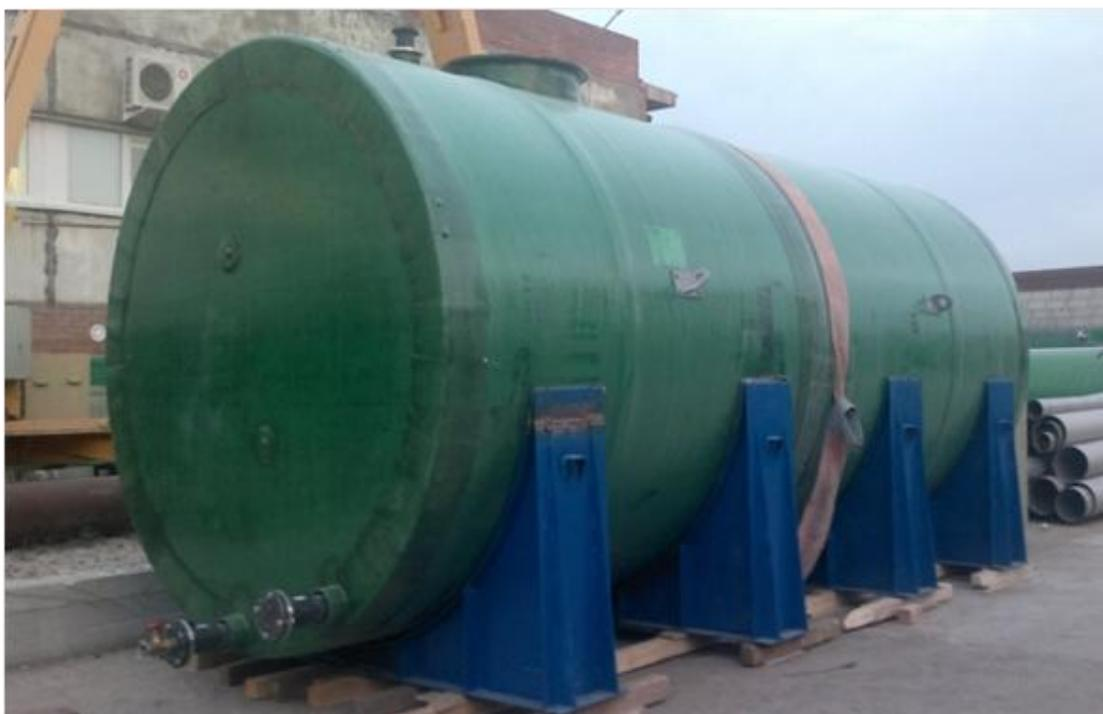
Рисунок 4.11 – Стеклопластиковая емкость перед отгрузкой
