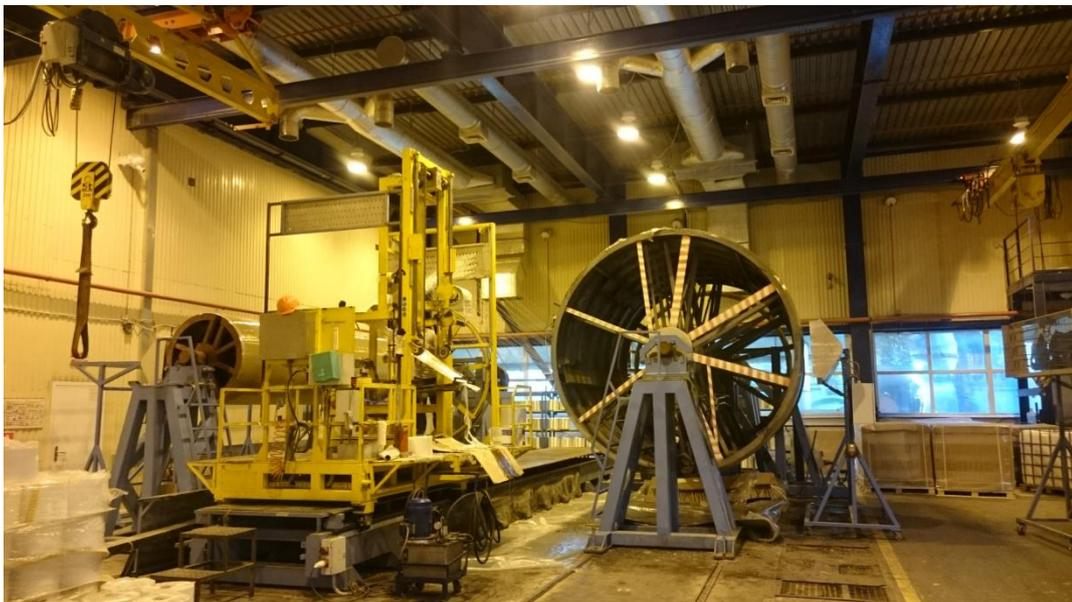
Рисунок 4.1 – 2-х шпиндельный намоточный станок с ЧПУ
