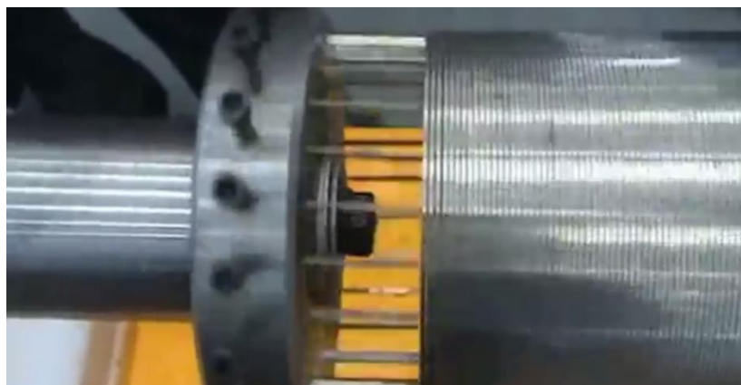
Рисунок 3.3 – Изготовление водоприемно-дренажного устройства на специальном станке
