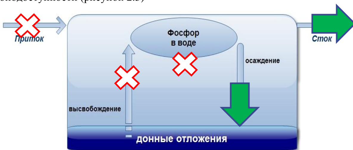
Рисунок 2.3 – Схема сокращения поступления фосфора в поверхностные воды и снижения его биодоступности
