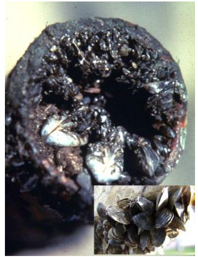
Рисунок 1.16– Блокирование насоса и трубопровода дрейссеной
