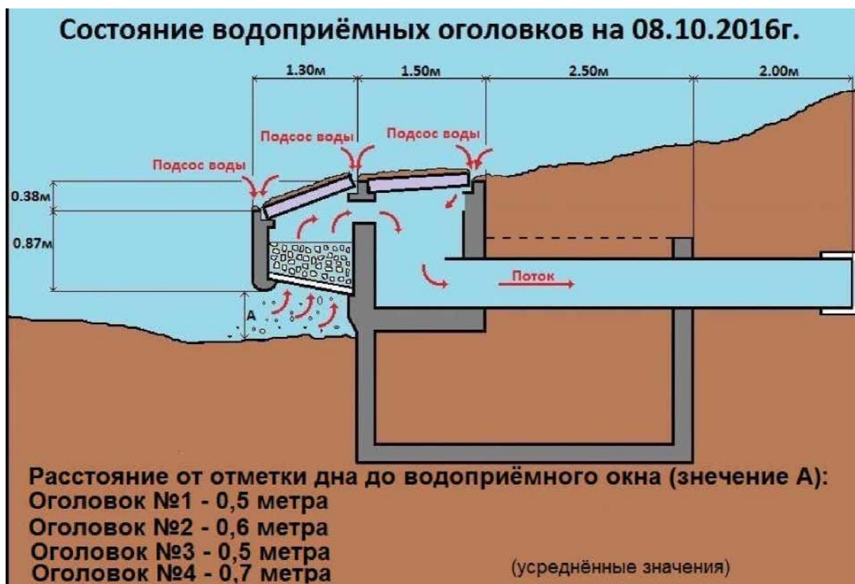
Рисунок 18 – Состояние водоприёмных оголовков на 08.10.2016г.
