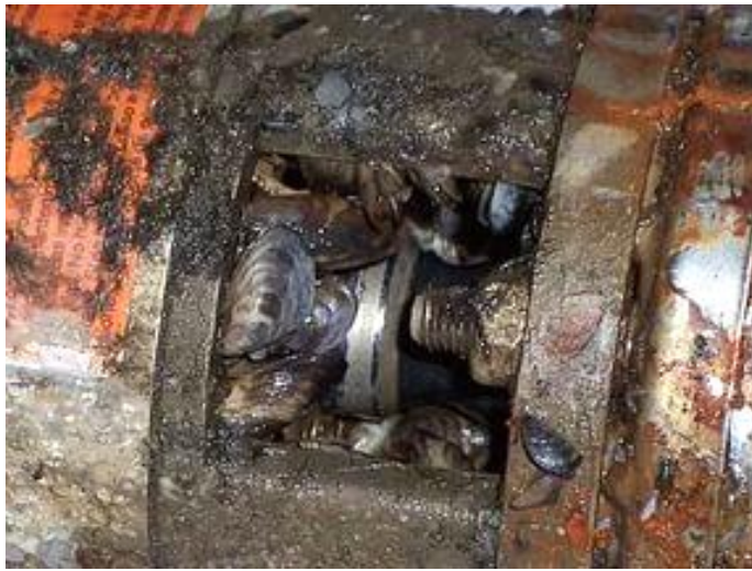
Рисунок 1.16– Блокирование насоса и трубопровода дрейссеной
