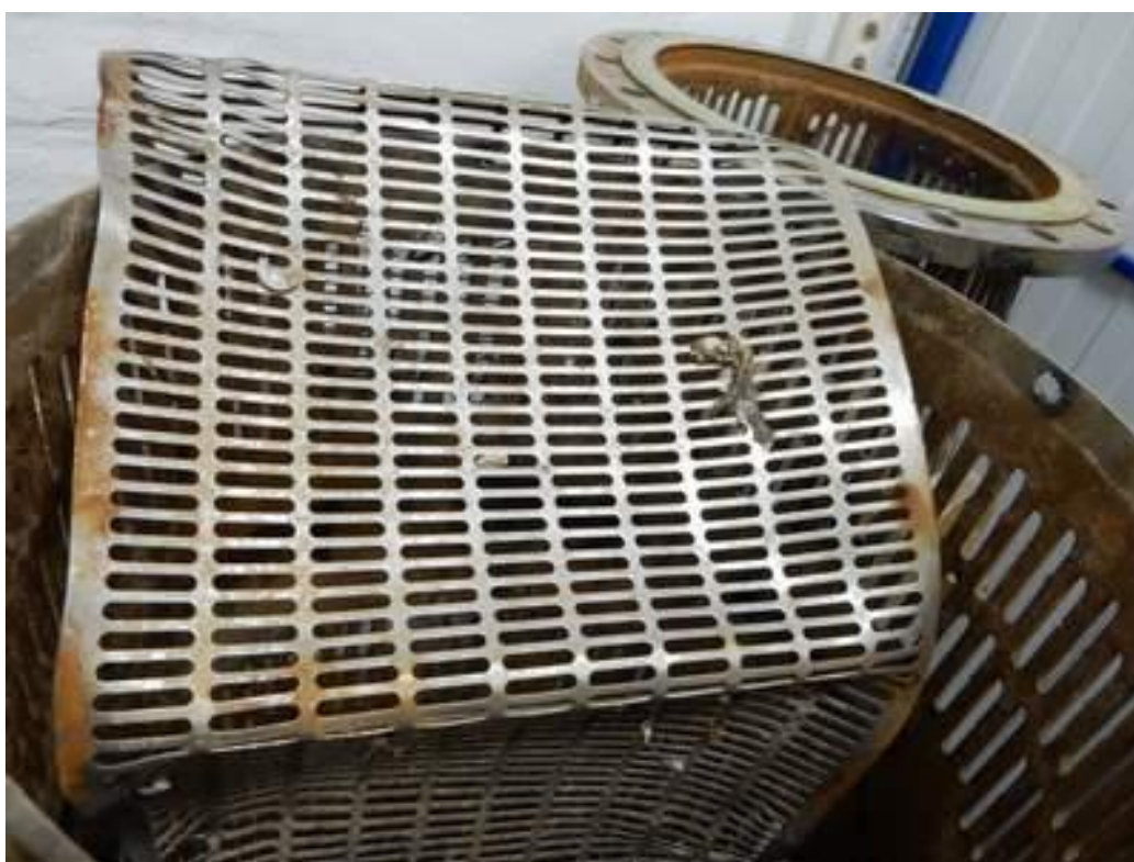
Рисунок 2.26–внутренняя решетка подверженная деформации
