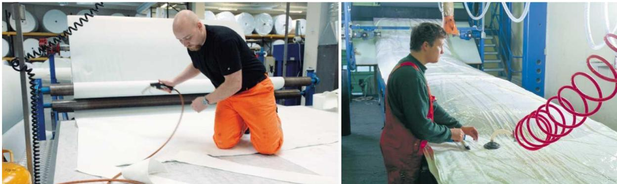
Рисунок 3.5 – Процесс производства полимерного рукава
