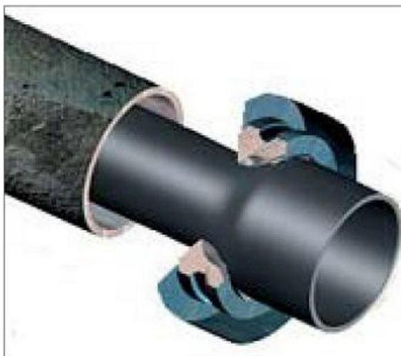
Рисунок 2.13 – Сужающая коническая матрица «Swagelining»
