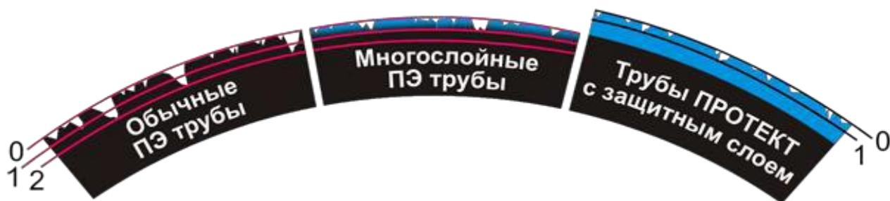
Рисунок 2.6 – Полиэтиленовая труба с защитной оболочкой
