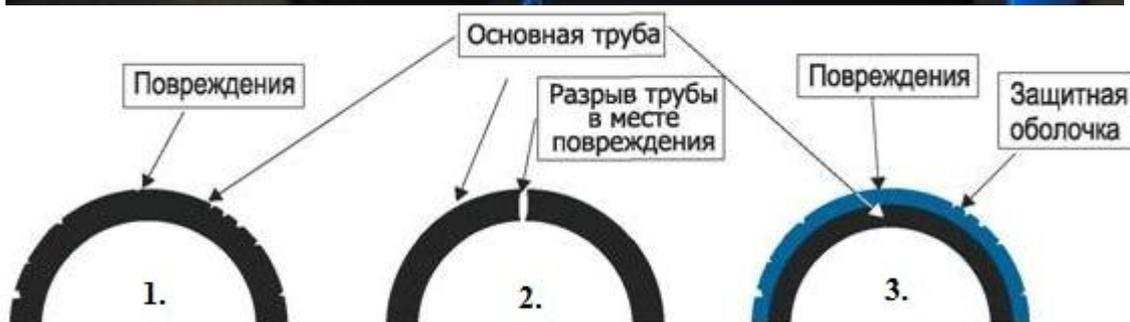
Рисунок 3.3 – Полиэтиленовые трубы с защитным покрытием ПРОТЕКТ и PROSAFE
