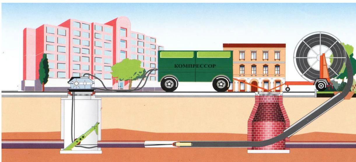
Рисунок 2.4 – Восстановление участка ветхой водопроводной сети без разрушения с помощью полимерных труб
