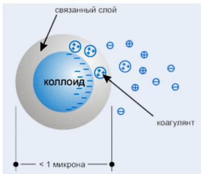
Рисунок 2.8 – Схема нейтрализующего действия реагента
