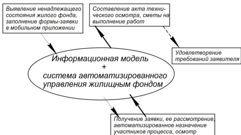
Рисунок 41 - Организация устранения неисправности с применением систем автоматизации
