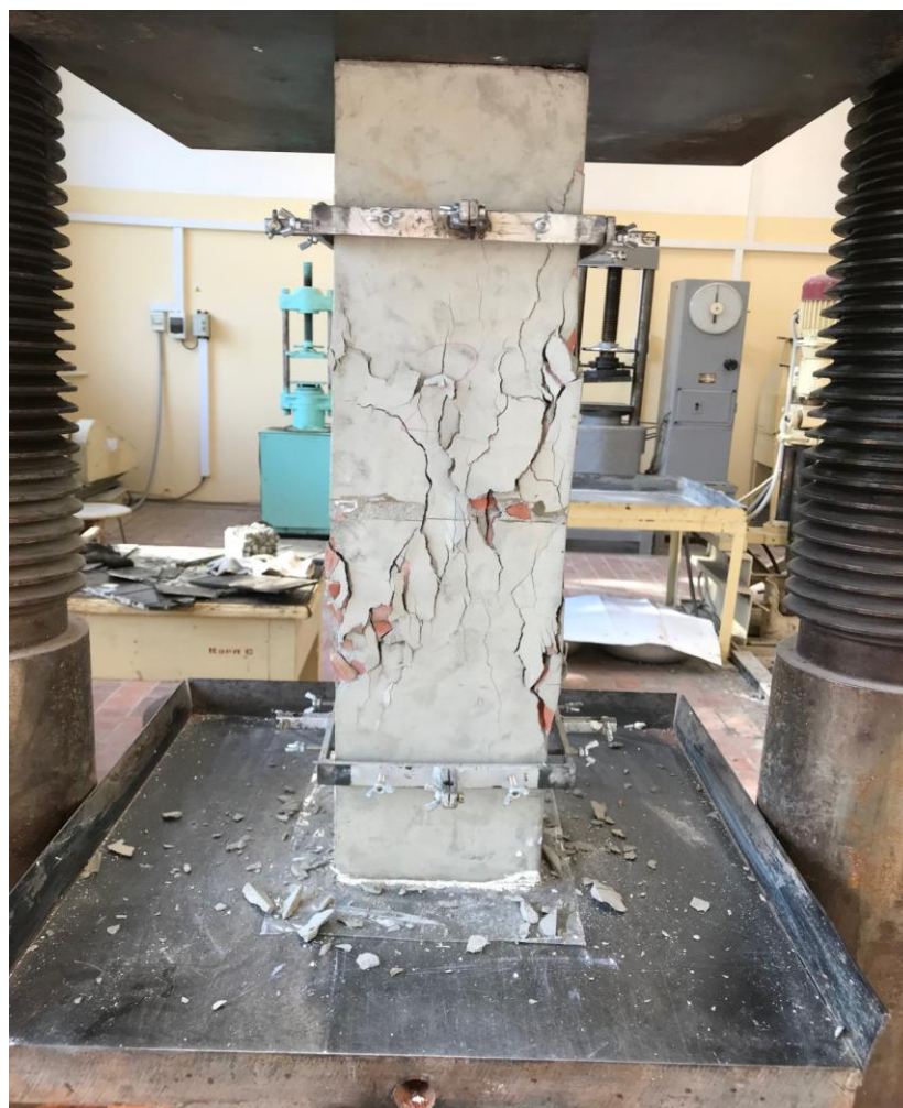
Рисунок 2.21 – Испытание призма на сжатие
