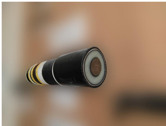
Рисунок 4.1 – Кабель ПвПпнг(А)2гж – НФ 1х1600/95 в разрезе
