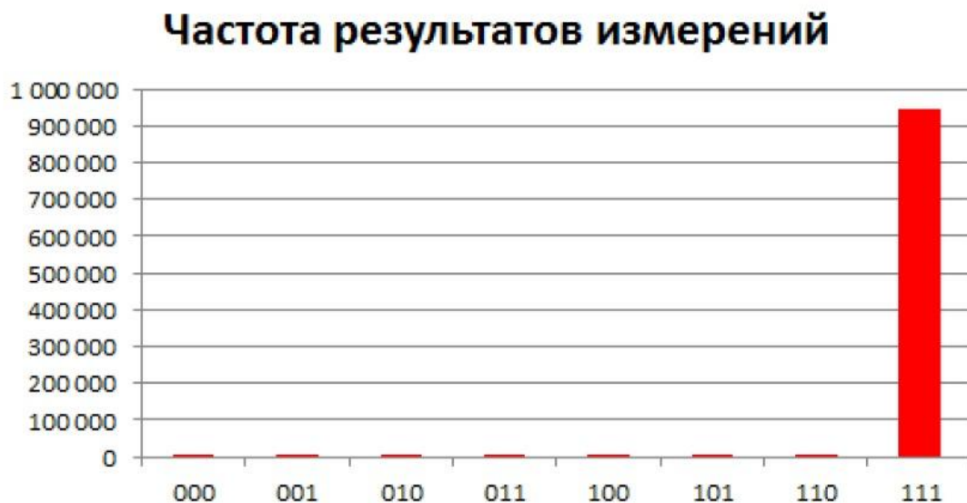
Рисунок 4.1 - Гистограмма частот получения результатов в алгоритме Гровера для трёх кубитов.
