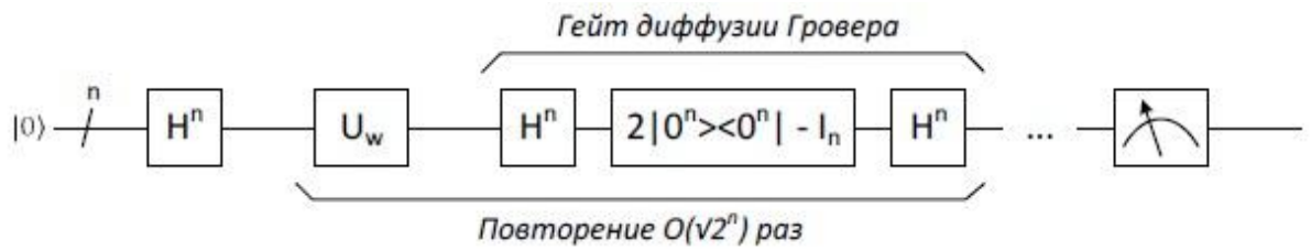
Рисунок 2.19 - Общая диаграмма квантовой схемы алгоритма Гровера
