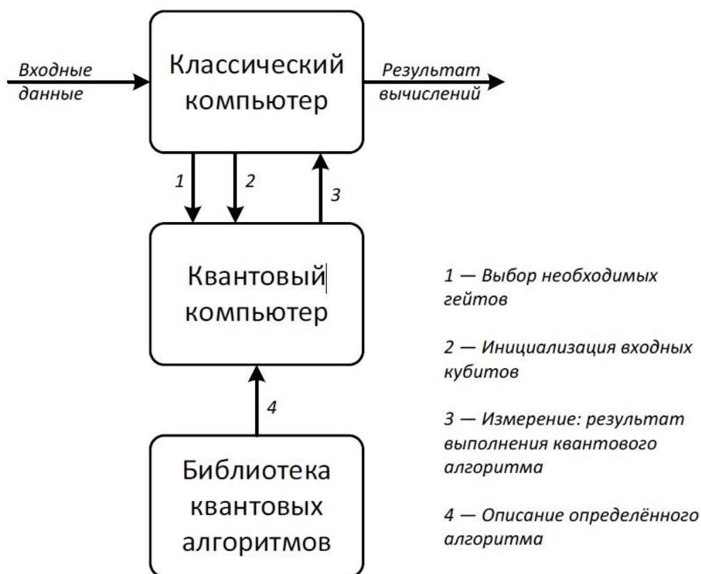
Рисунок 2.14 - Общая архитектура квантового компьютера
