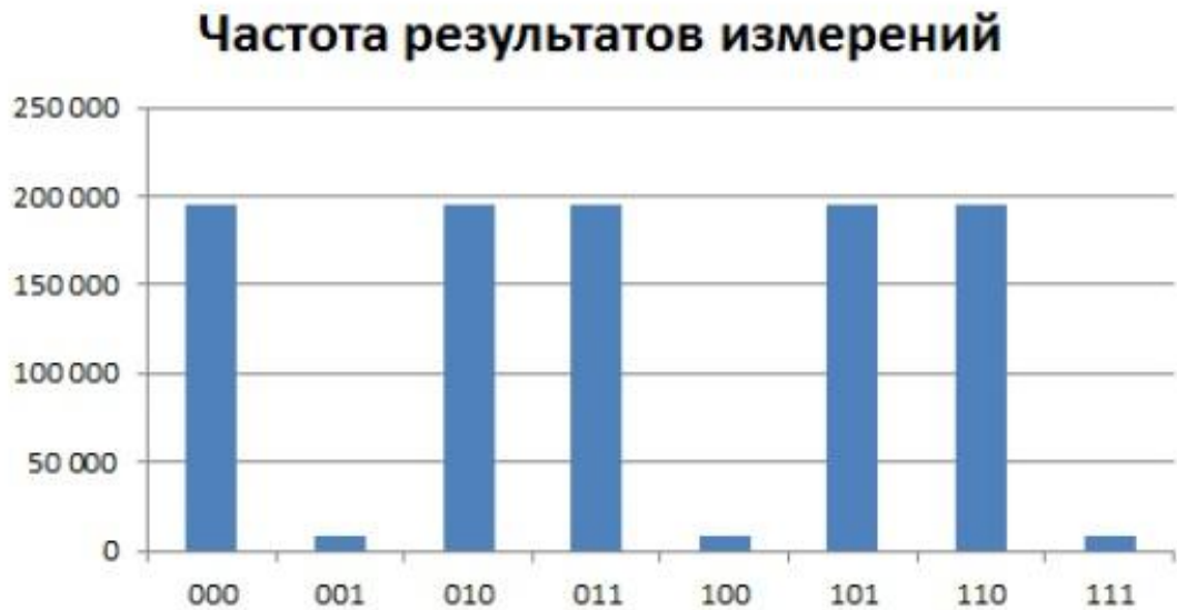
Рисунок 4.2 - Гистограмма частот получения результатов в алгоритме Гровера для трех кубитов с тремя правильными ответами
