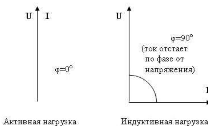
Рисунок 1- Сущность возникновения реактивной мощности
